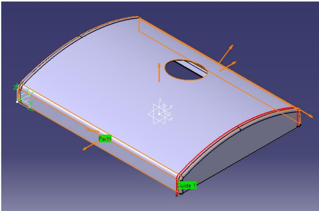
Slika 14. Kontaktne površine i krivulja vođenja alata
