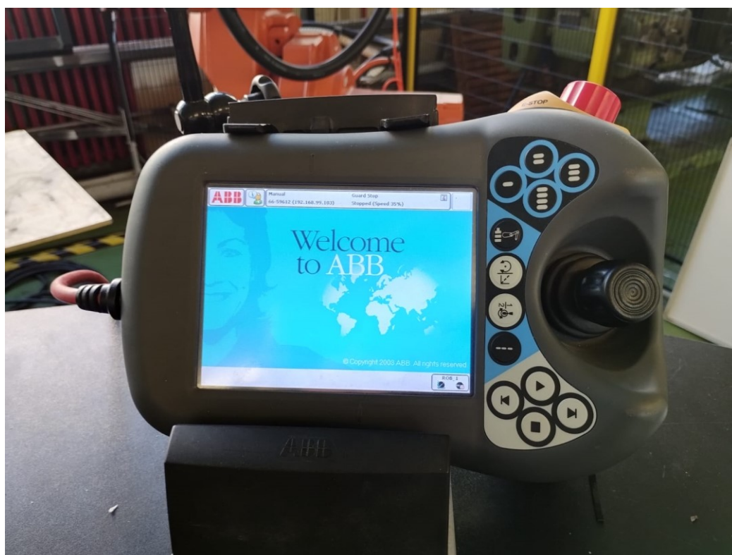
Slika 3. Privjesak za učenje robota ABB IRB 6640-235/2.55
