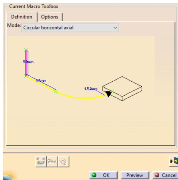
Slika 15. Tangencijalni ulaz alata u zahvat s obratkom
