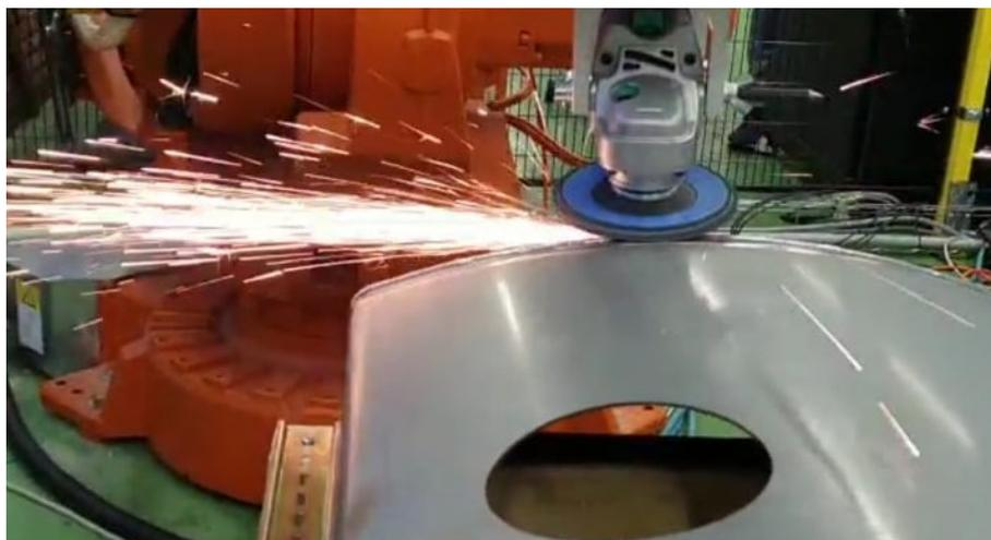
**Slika 35. Ispitivanje brušenja zavara**
