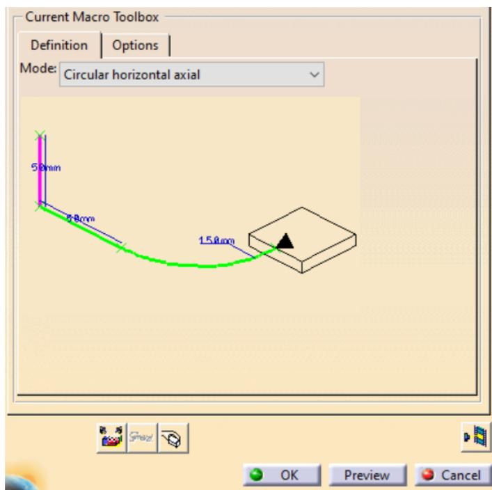
Slika 16. Tangencijalni izlaz alata iz zahvata s obratkom
