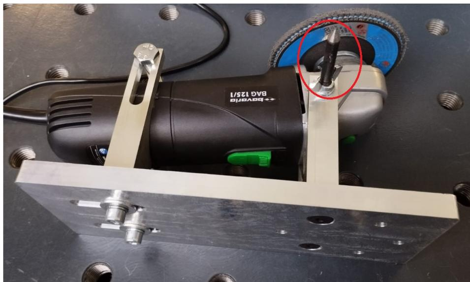
Slika 29. Šiljak montiran na brusilici
