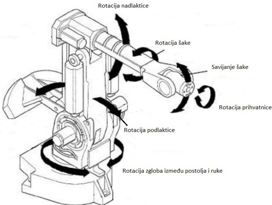
Slika 5. Stupnjevi slobode gibanja robota ABB IRB 6640-235/2.55
