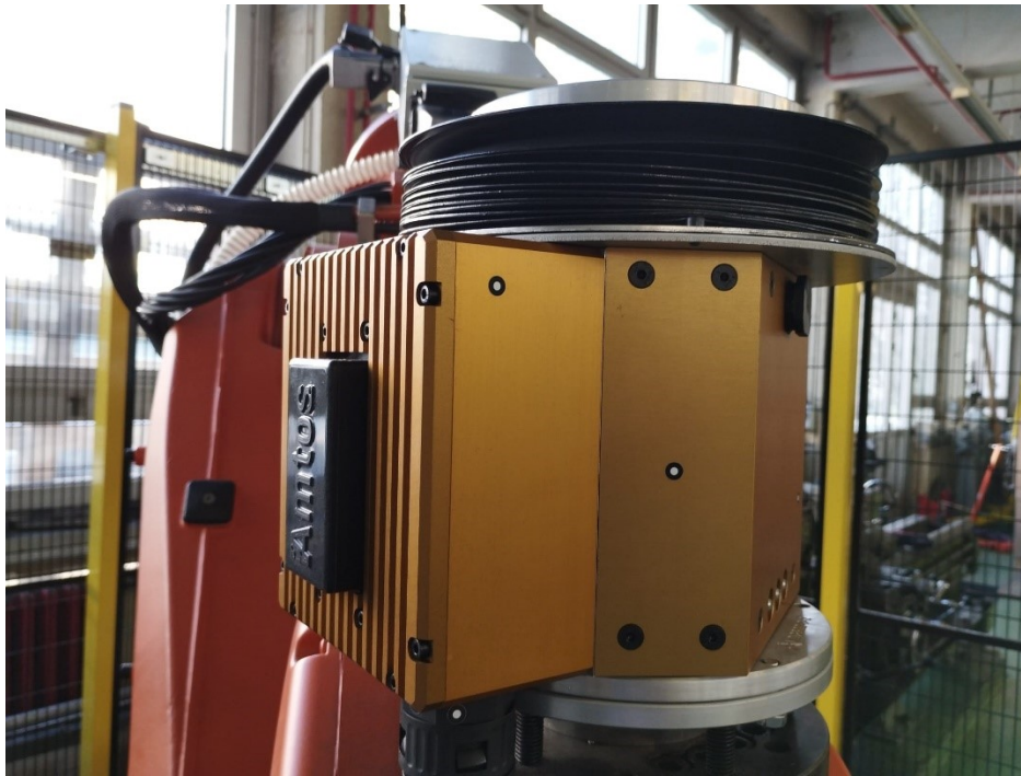
Slika 6. Prigon za regulaciju aksijalne sile
