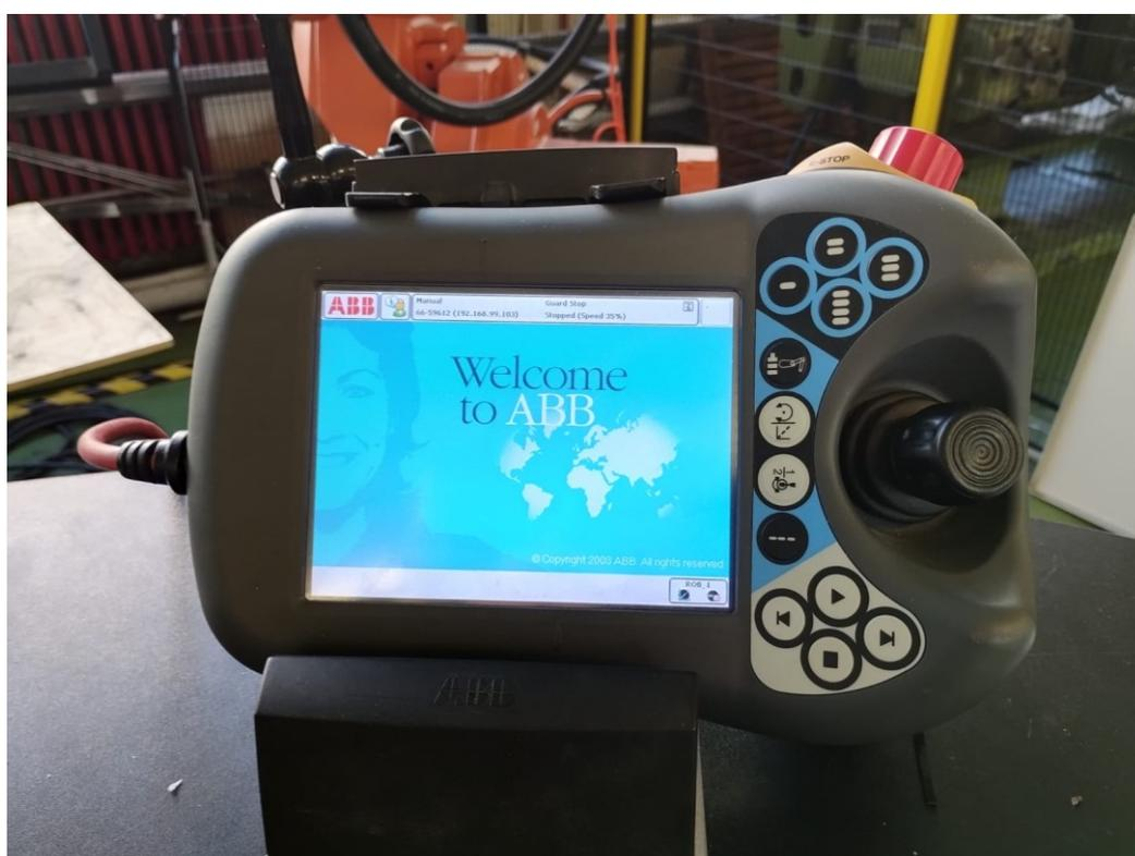
Slika 3. Privjesak za učenje robota ABB IRB 6640-235/2.55
