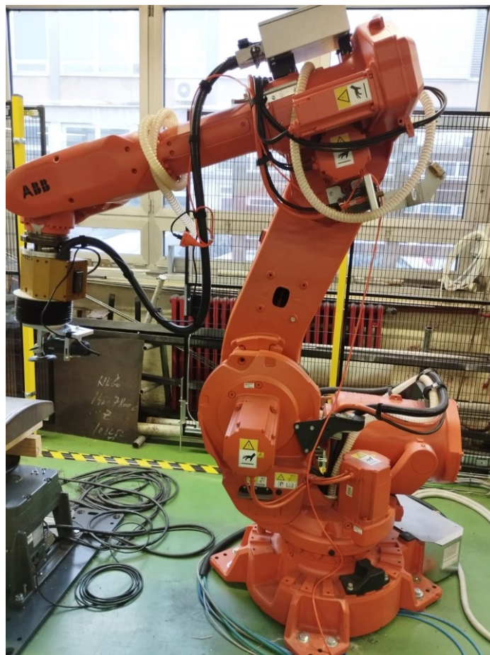
Slika 1. Industrijski robot ABB IRB 6640-235/2.55
