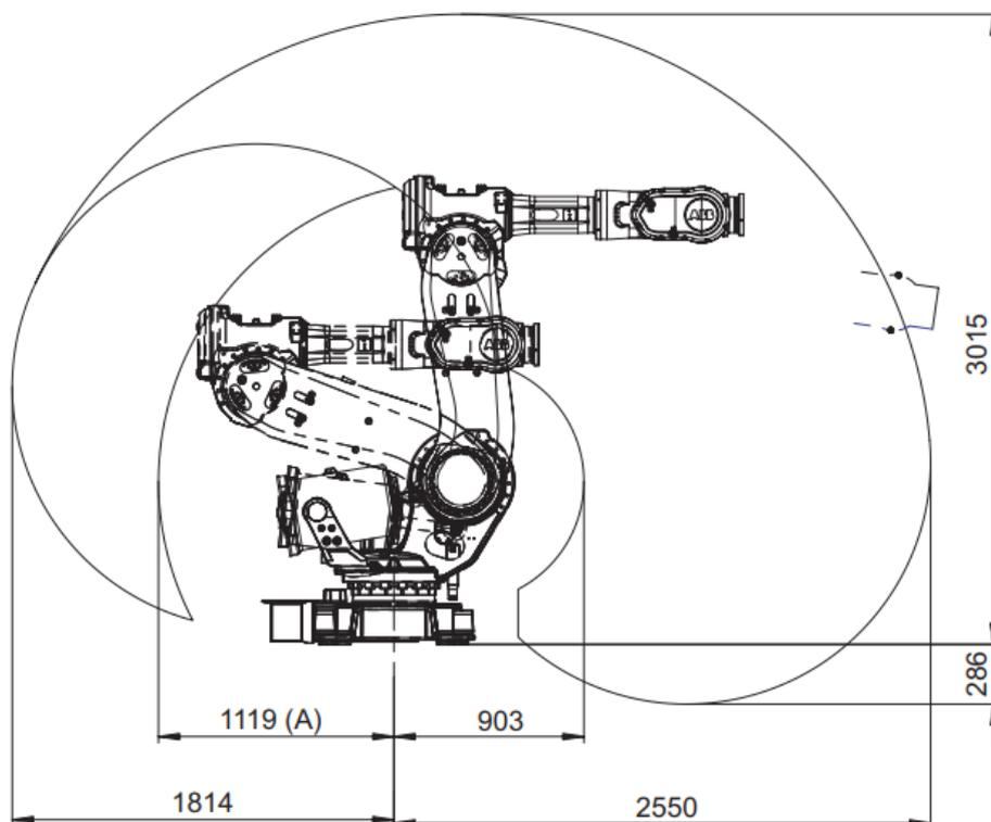
Slika 4. Doseg robota ABB IRB 6640-235/2.55 [4]
