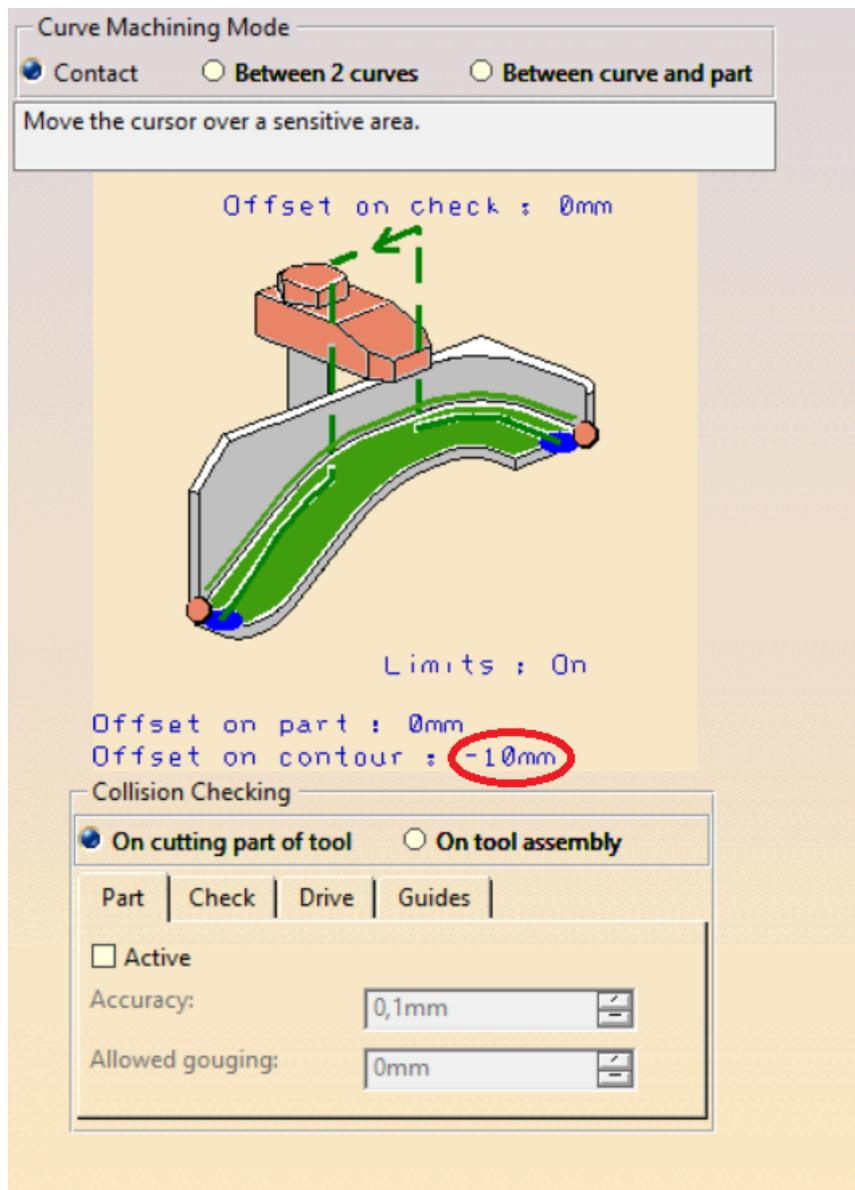
Slika 18. Pomak alata u negativnom smjeru osi x
