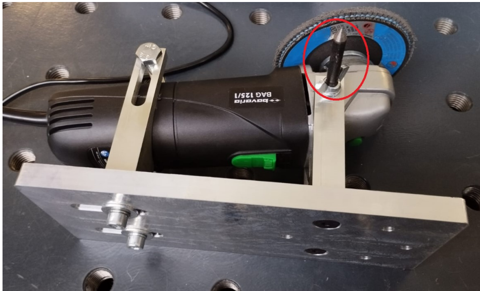
Slika 29. Šiljak montiran na brusilici
