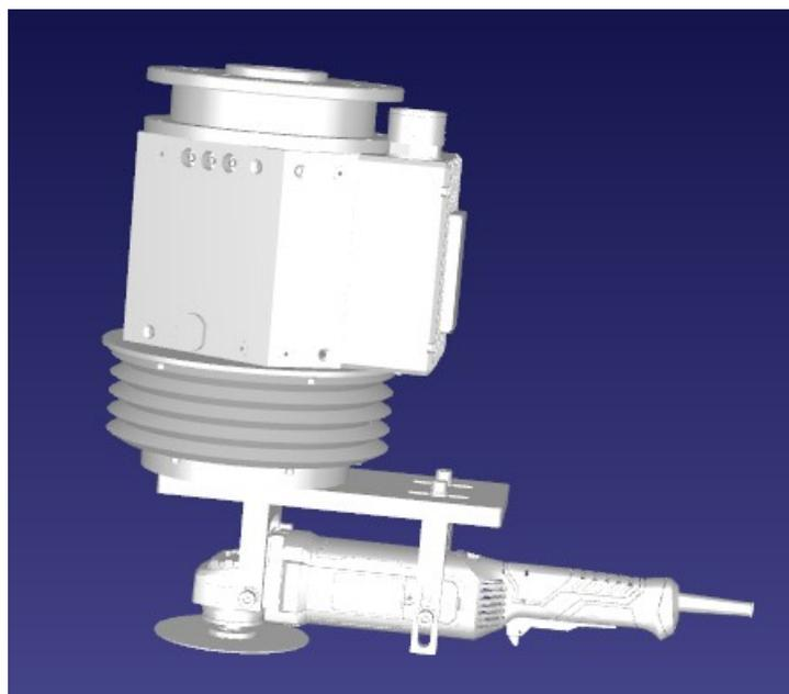
Slika 28. 3D model sklopa alata i prigona za regulaciju aksijalne sile
