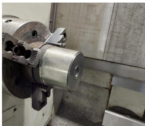
Slika 20. Stezanje pripremka u CNC tokarski obradni centar
