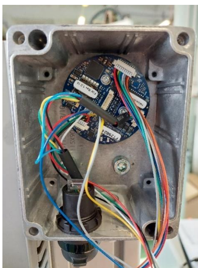
Slika 17. Ugrađena razvodna kutija
