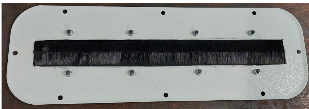
Slika 10. Pogled na metlice na poklopcu upravljačkog ormara iznutra
