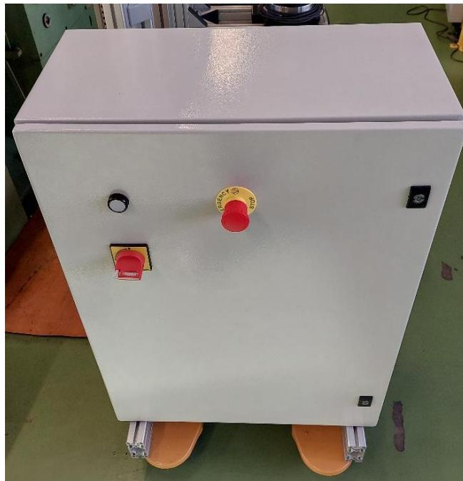
**Slika 13. Sklopka i tipkala na vratima upravljačkog ormara**
