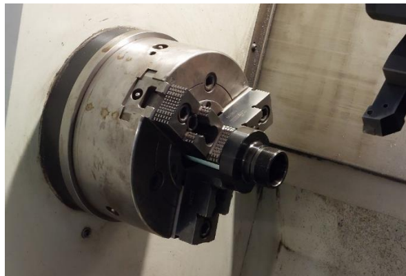
Slika 24. Stezanje stezne glave u CNC tokarski obradni centar
