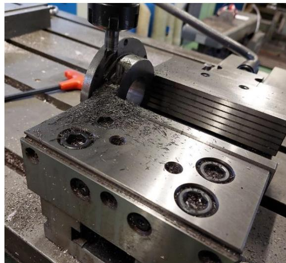
Slika 21. Izrada utora na CNC glodalici
