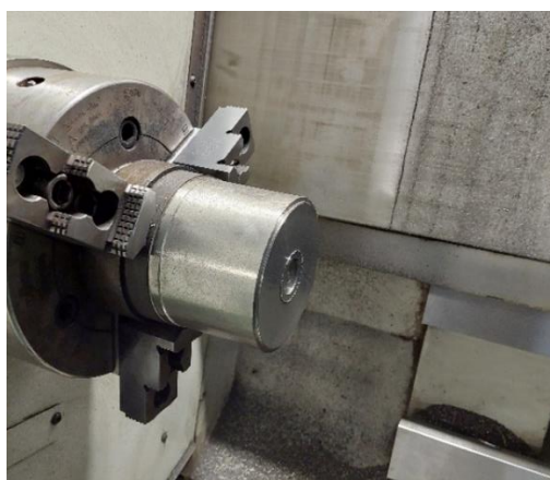
Slika 20. Stezanje priprema u CNC tokarski obradni centar
