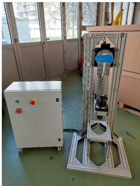
Slika 29. Izrađen postav zračnog tunela
