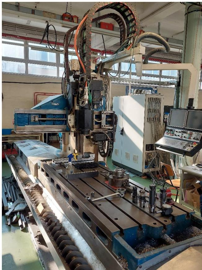
**Slika 7. Laboratorijska 3-osna CNC glodalica**
