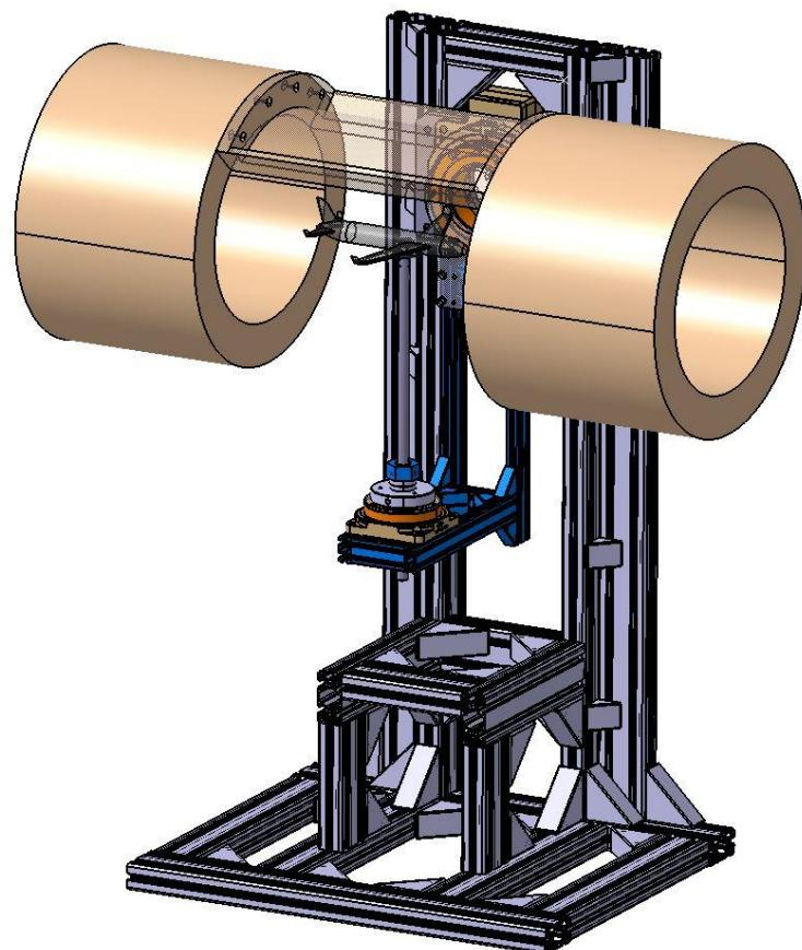
Slika 4. Model ispitnog postava zračnog tunela
