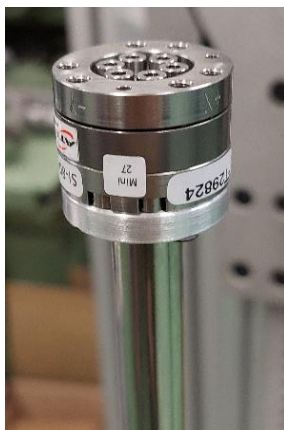
Slika 27. Izrađena i ugrađena prirubnica za prihvat senzora sila
