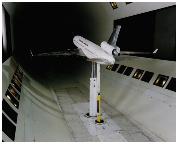
Slika 3. Ispitivanje modela zrakoplova u zračnom tunelu NASA-e [2]
