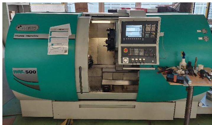
**Slika 6. Trens SBL 500 CNC tokarski obradni centar**
