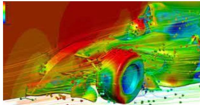
Slika 2. Virtualna simulacija pomoću računalne dinamike fluida [3]
