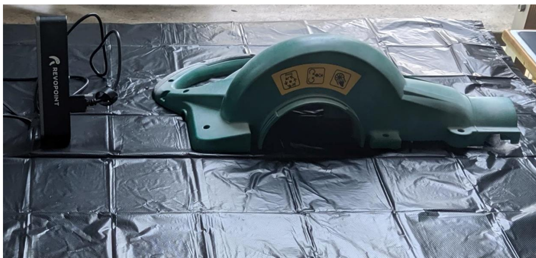
Slika 17. Pripremljeno kućište Bosch puhalice za ručno skeniranje
