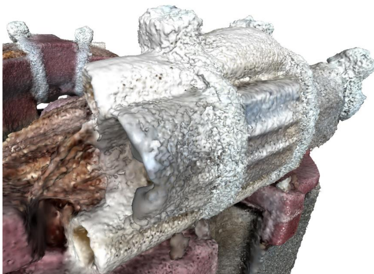
Slika 35. Anomalije na površini pri vrijednosti dubine rekonstrukcije od 10
