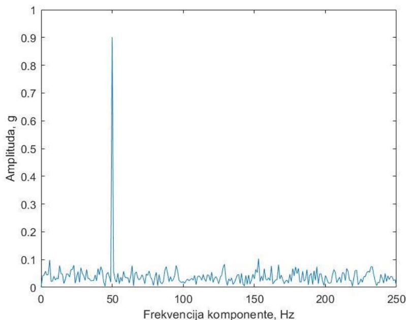
**Slika 6: Frekvencijska karakteristika zašumljenog signala**
