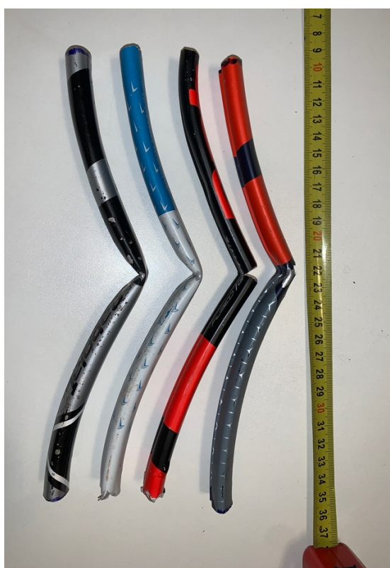
Slika 21. Ispitna tijela nakon ispitivanja
