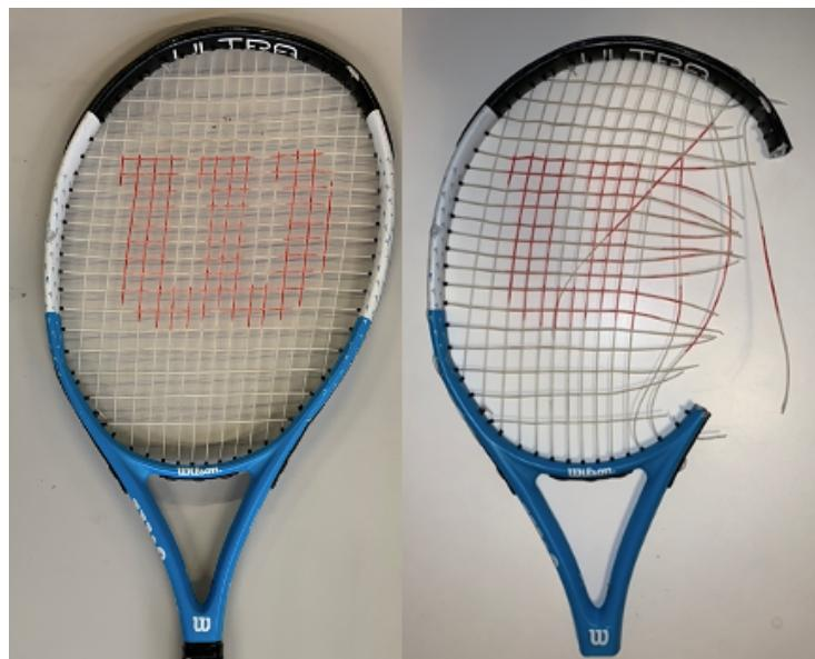
**Slika 15. Reket prije i nakon izrezivanja ispitih tijela**
