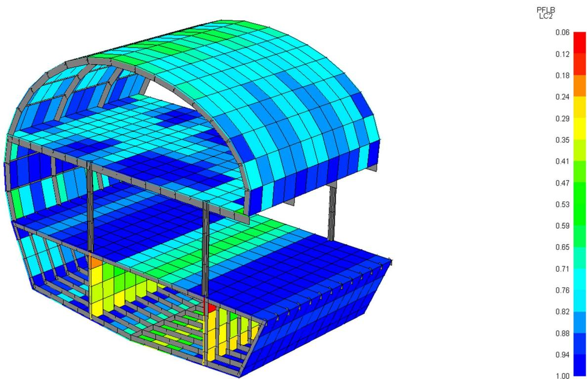
Slika 25. Vrijednost faktora podobnosti za kriterij PFLB redimencioniranog modela za LC 2
