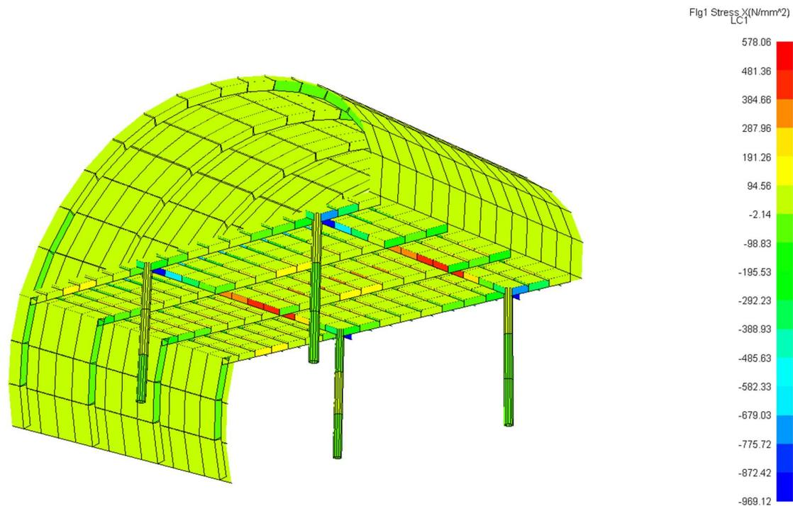
Slika 12. Ukupna aksijalna i savojna naprezanja u prirubnicama jakih poprečnih nosača za LC1
