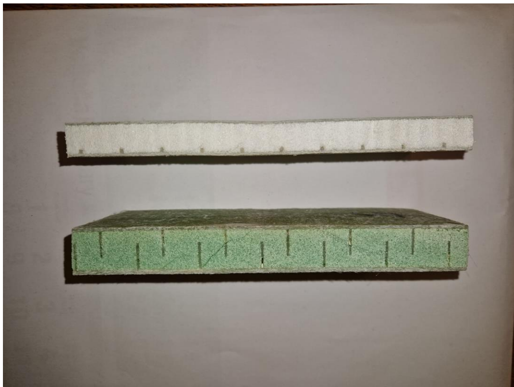
Slika 5.4 Ispitna tijela tanjeg i debljeg sendviča
