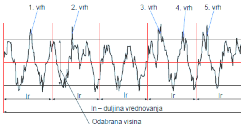
Slika 30: Definiranje parametra P_c , odnosno broja vrhova elementa profila, [18]
