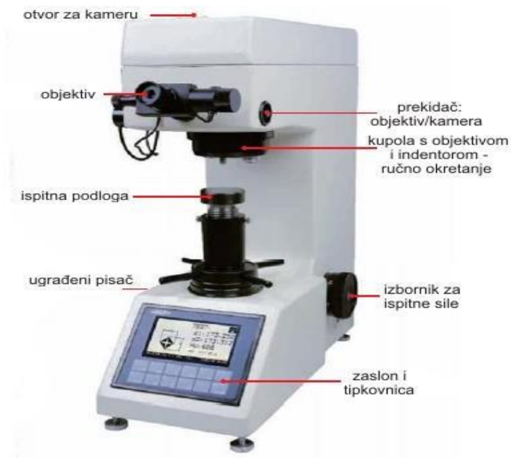
Slika 17. Mikroskop za mjerenje tvrdoće po Vickersu [16]
