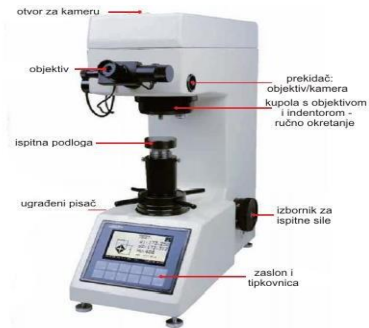
Slika 17. Mikroskop za mjerenje tvrdoće po Vickersu [16]
