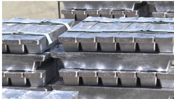
Slika 7. Ingoti olova nakon rafinacije [12]
