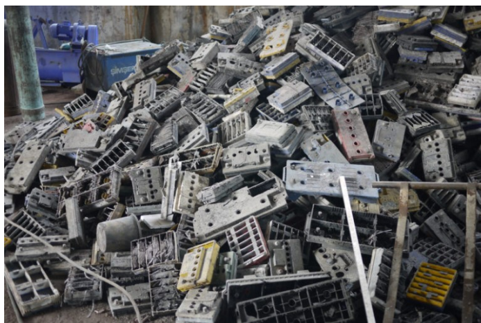
Slika 19. Rastavljeni akumulatori za recikliranje [31]
