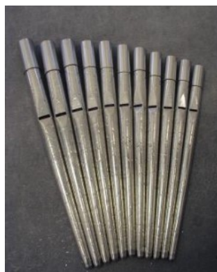
Slika 15. Olovne cijevi za orgulje [24]
