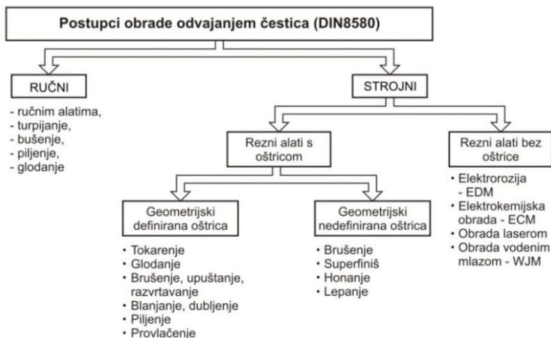
Slika 2. Podjela postupaka obrade odvajanjem čestica [2]
