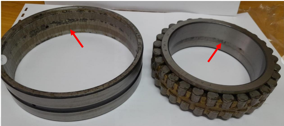
Slika 17. Tragovi trošenja ležaja
