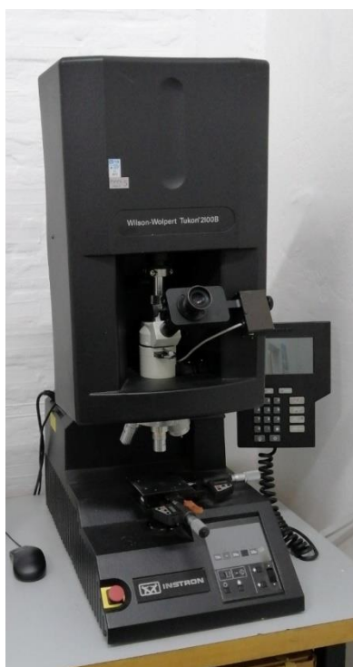
Slika 20. Tvrdomjer Wilson-Wolpert Tukon 2100B
