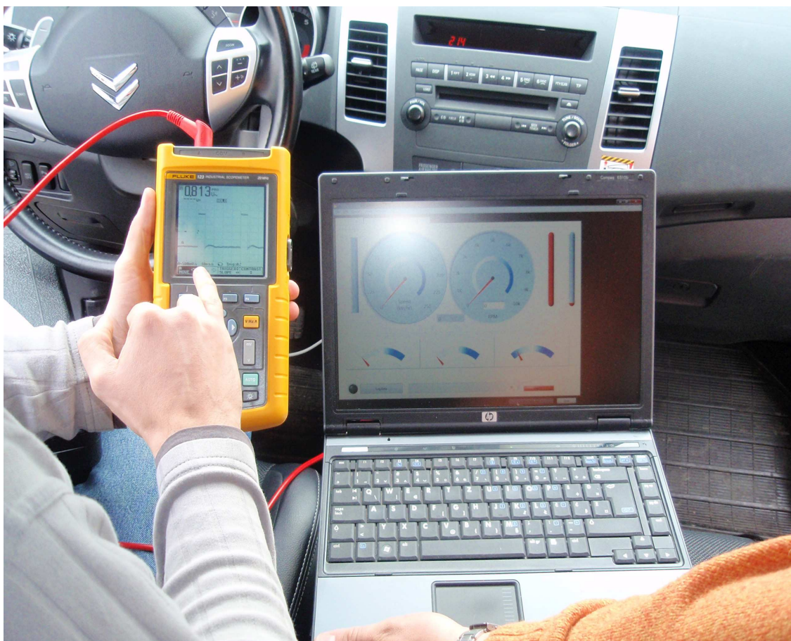
Slika 7.9. Očitavanje signala sa CAN sabirnice pomoću osciloskopa.
