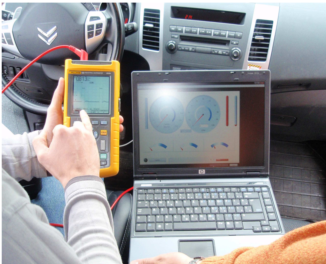
Slika 7.9. Očitavanje signala sa CAN sabirnice pomoću osciloskopa.
