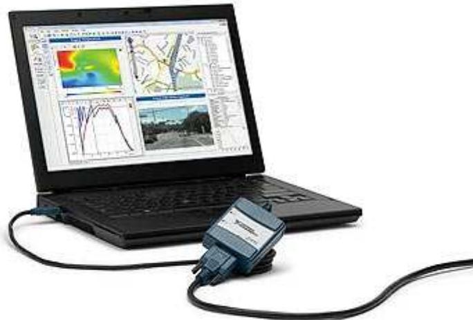
*Slika 6.14. Fotografija prikazuje uređaj NI USB 8473s spojen sa računalom te izgled obrađenih podataka prikupljenih sa CAN sabirnice.*
