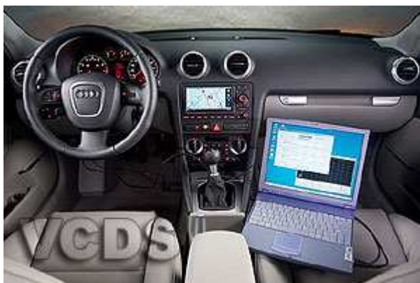
Slika 6.9. VAG KKL CAN komplet priključen na vozilo marke Audi.
