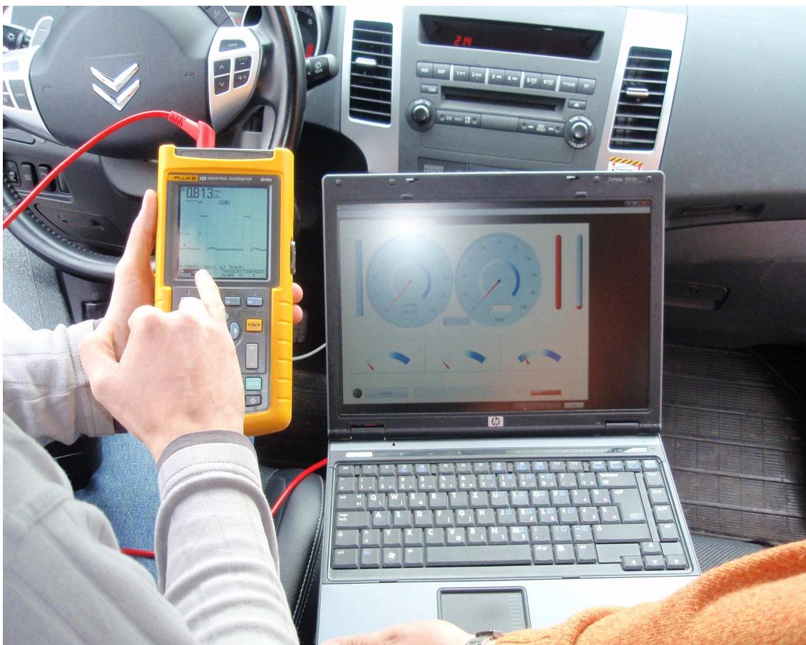
Slika 7.9. Očitavanje signala sa CAN sabirnice pomoću osciloskopa.
