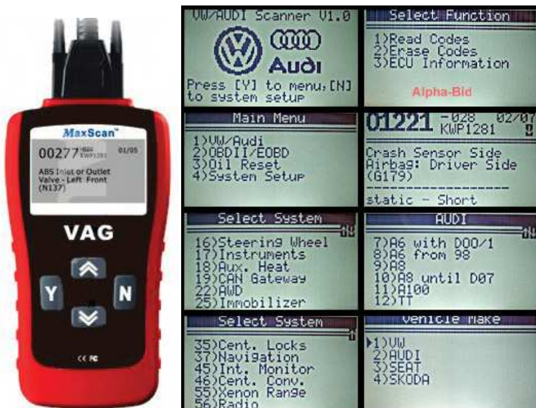
Slika 6.4. Uređaj VAG405 (lijevo); izgled pojedinih izbornika uređaja (desno).
