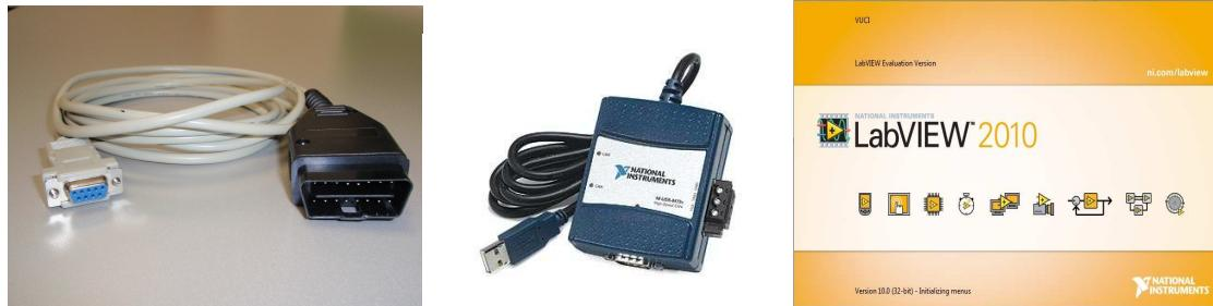
Slika 7.1. Uobičajeni komplet za analizu i prikupljanje podataka sa CAN sabirnicice motornog vozila.
