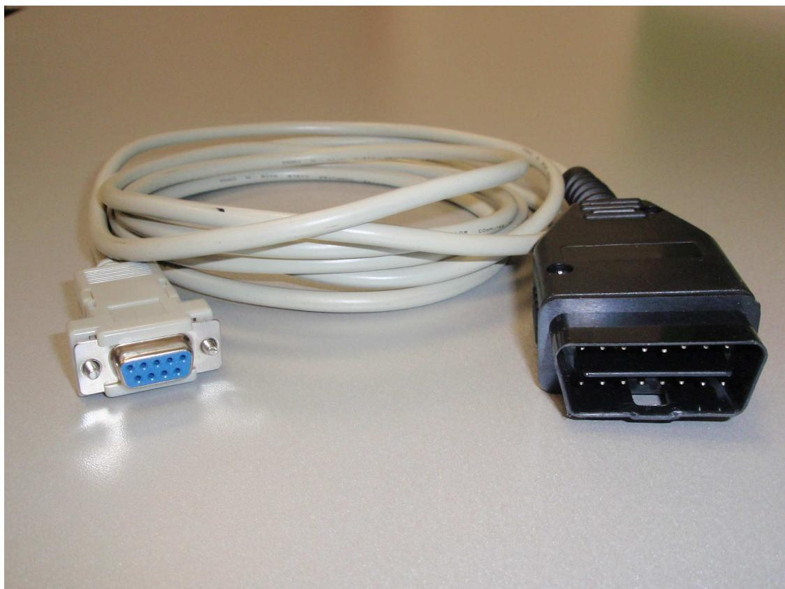
*Slika 7.6. Konačni izgled spojnog kabela EOBD – DB9 (RS232).*
