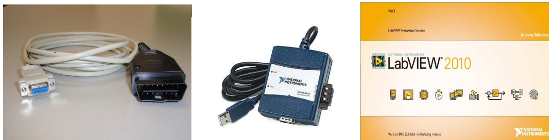
Slika 7.1. Uobičajeni komplet za analizu i prikupljanje podataka sa CAN sabirnice motornog vozila.
