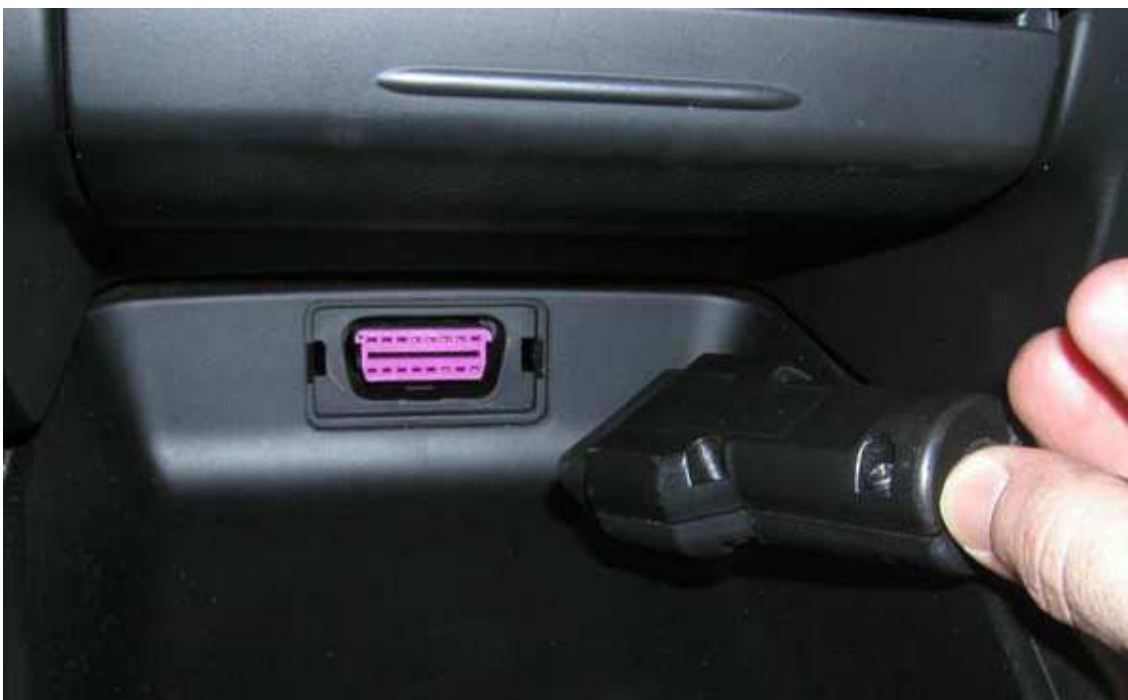
Slika 2.6. Položaj CARB priključnice na vozilu Audi A3 nalazi se dolje lijevo od kola upravljača, ispod prekidača za svjetla (fotografija je snimljena nakon što je skinut poklopac na priključnici) [1].
