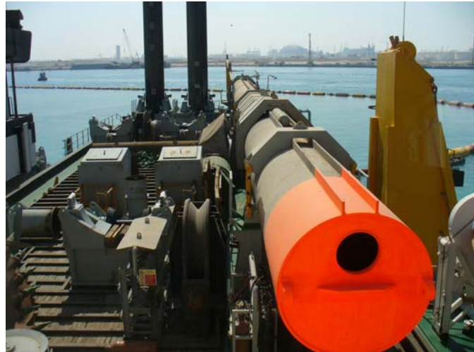
Slika 14. : Glavni i pomoćni pilon u uspravnom položaju, rezervni u položaju morskog veza
