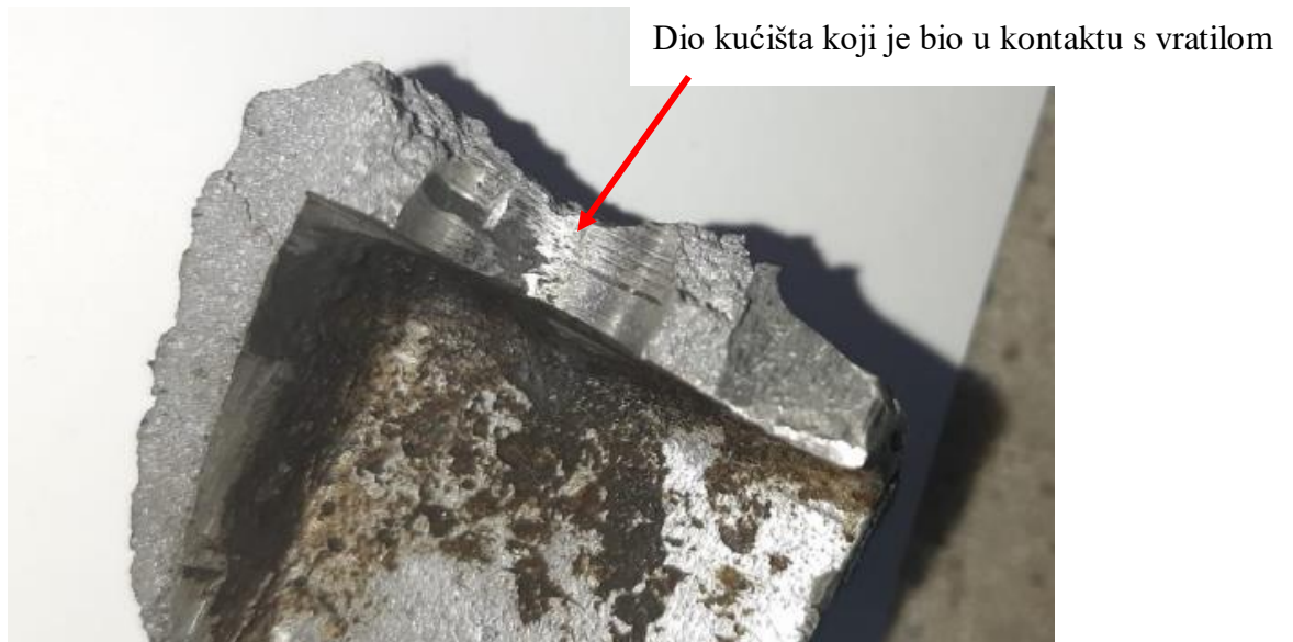
Slika 34. Izrezano kućište na mjestu kontakta s vratilom
