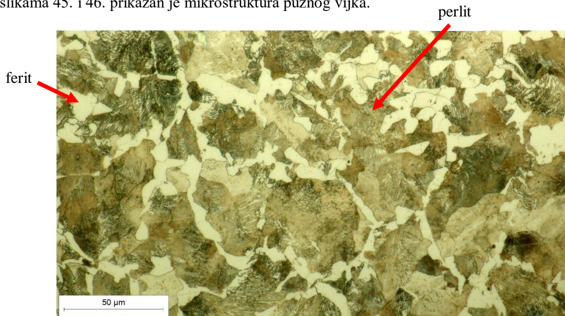
Slika 44. Mikrostruktura sredine presjeka pužnog vijka, uvećana 500x
