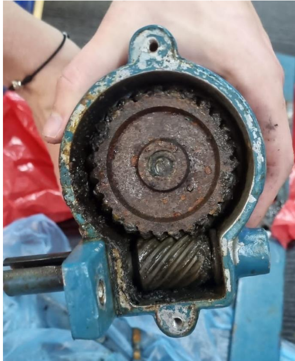
Slika 24. Pužni vijak i pužno kolo u otvorenom kućištu
