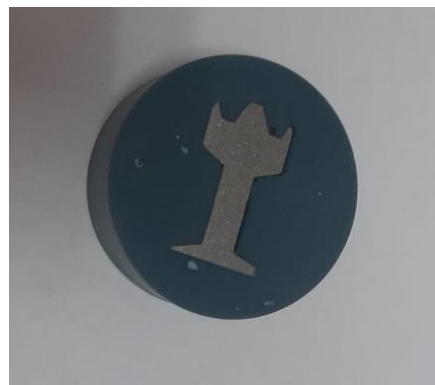
Slika 40. Izrezani uzorak pužnog kola u polimeru
