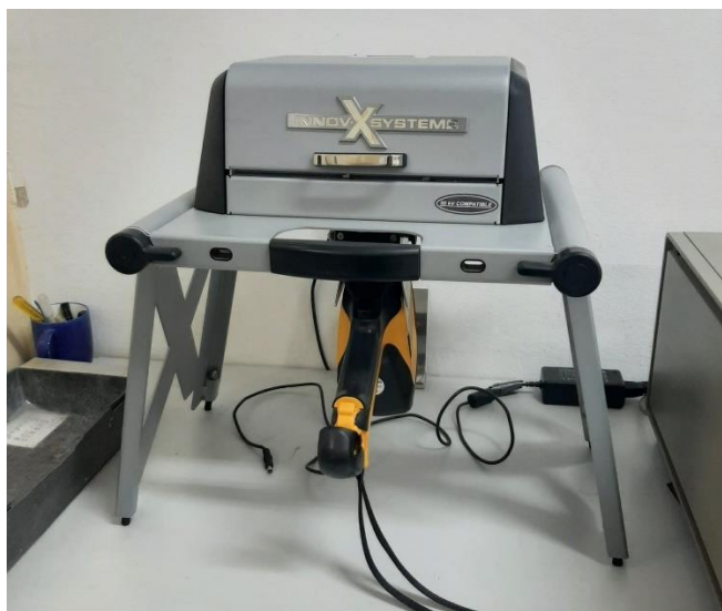
Slika 38. Olympus XRF uređaj za snimanje kemijskog sastava
