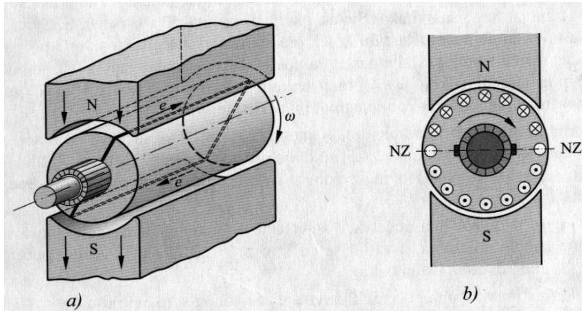
Slika 3.4. Načelni prikaz bубnjaste armature dvopolnog stroja: a) s ucrtanim jednim svitkom, b) u presjeku s više svitaka
