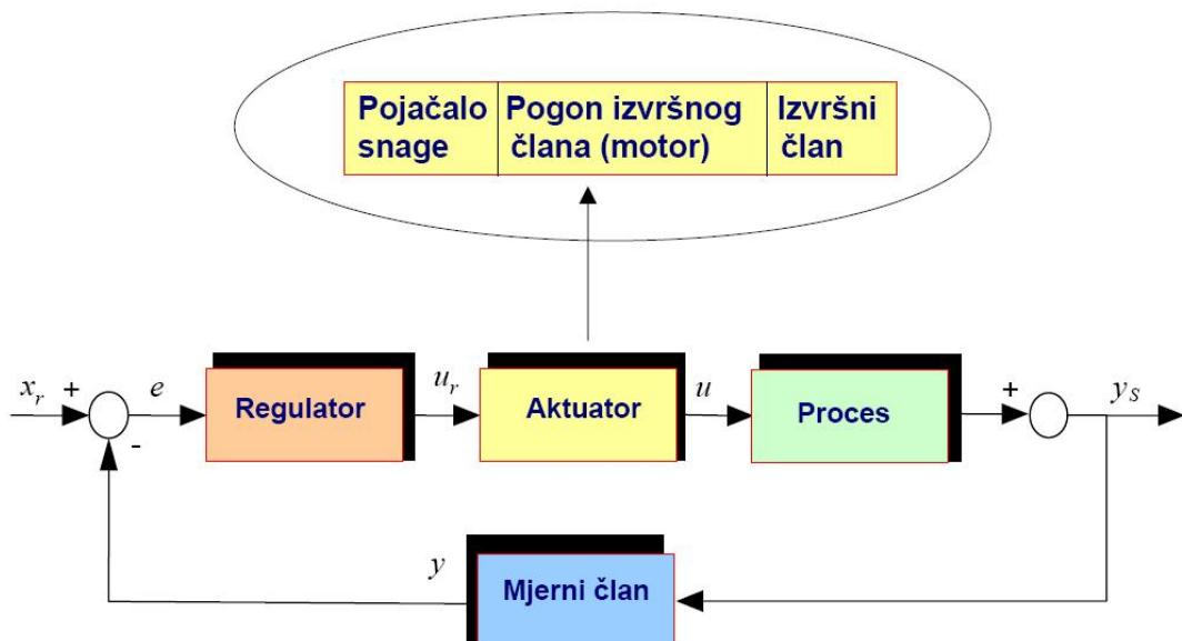
Slika 3.1. Komponente aktuatora [13]
