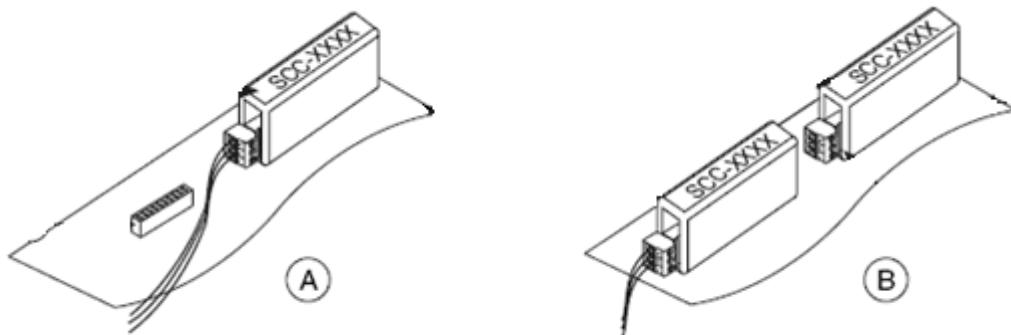
Slika 7.4. Kondicioniranje signala: a) jednostruko, b) dvostruko
