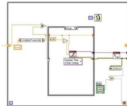
Slika 5.30. Spajanje modula unutar while i case petlje
