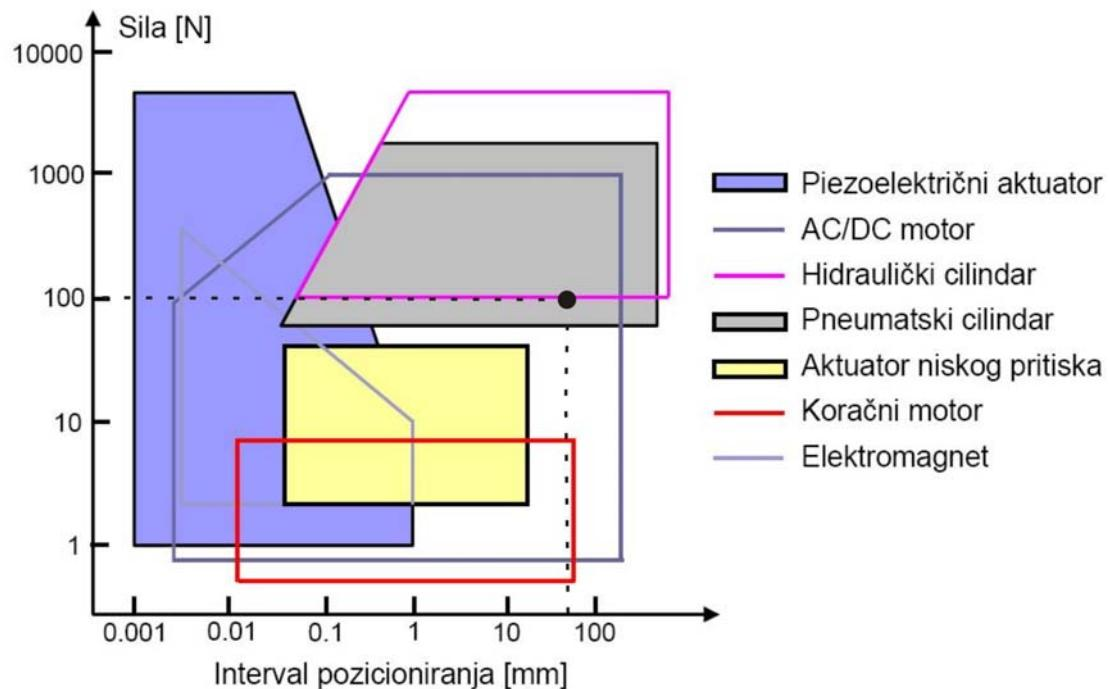
Slika 3.8. Ovisnost sile o intervalu pozicioniranja [6]
