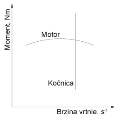
Slika 1.10. "Position/speed" način ispitivanja
