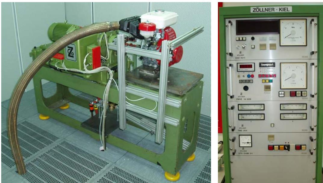
Slika 7.1. Kočnica za mjerjenje snage Zollner A100 AC
