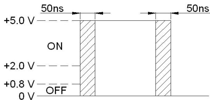
Slika 4.5. Određivanja promjena stanja signala
