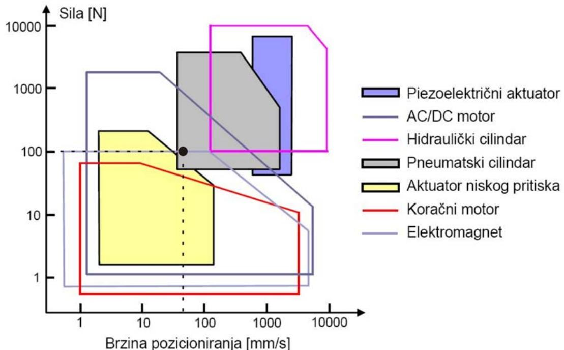
Slika 3.7. Ovisnost sile o brzini pozicioniranja [6]
