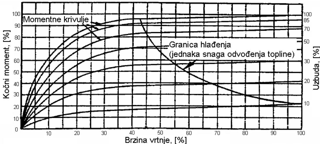
Slika 1.8. Promjena kočnog momenta u ovisnosti o jačini uzbude i brzini vrtnje
