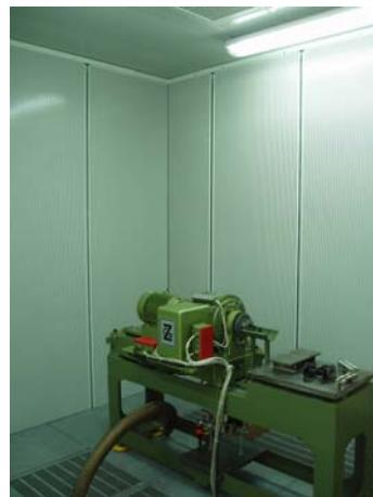
*Slika 1.2. Ispitna kabina za motore manjih snaga*
