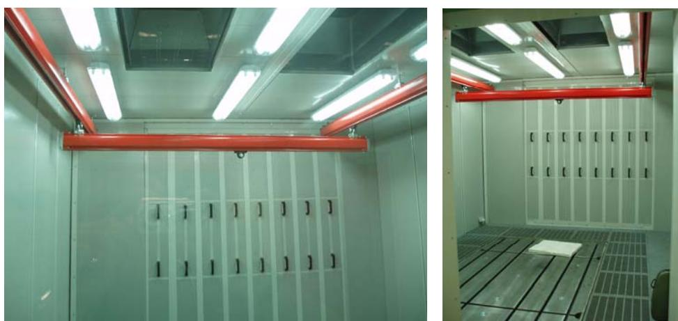
*Slika 1.3. Ispitna kabina za motore većih snaga*
