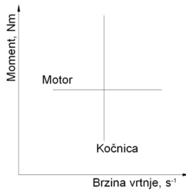
*Slika 1.13. "Torque/speed" način ispitivanja*
