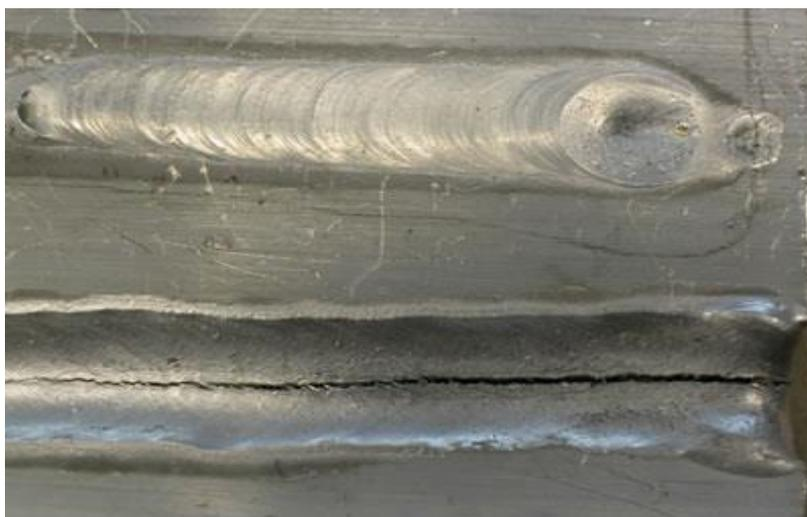
**Slika 15. Pojava pukotina na zavaru nakon hlađenja [14]**
