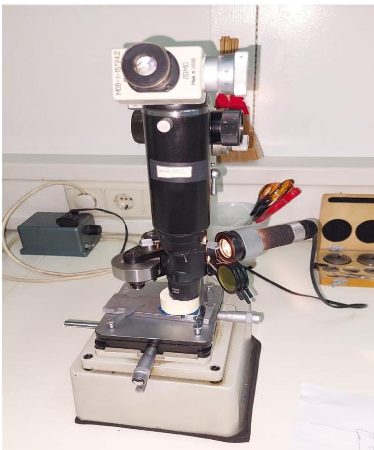
**Slika 49.** Uređaj za mjerenje mikrotvrdoće
