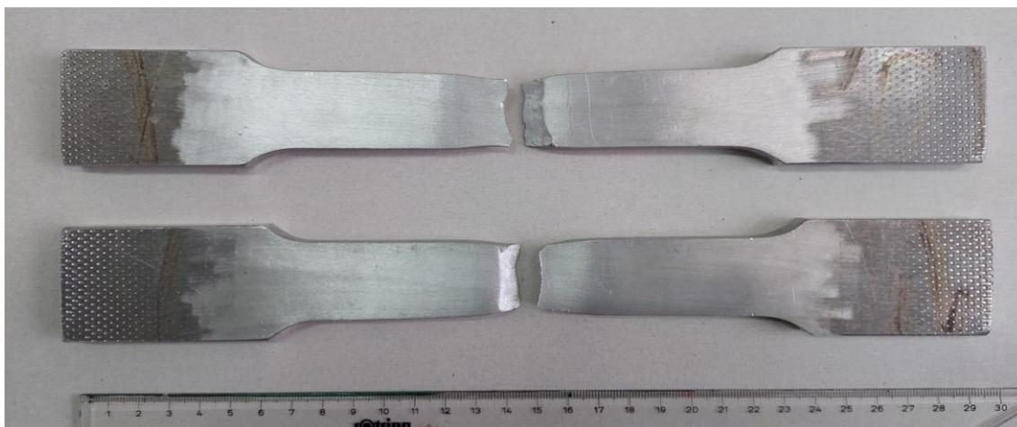
**Slika 53. Uzorci nakon ispitivanja vlačne čvrstoće**
