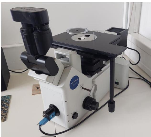
**Slika 31. Svjetlosni mikroskop za analizu mikrostrukture**
