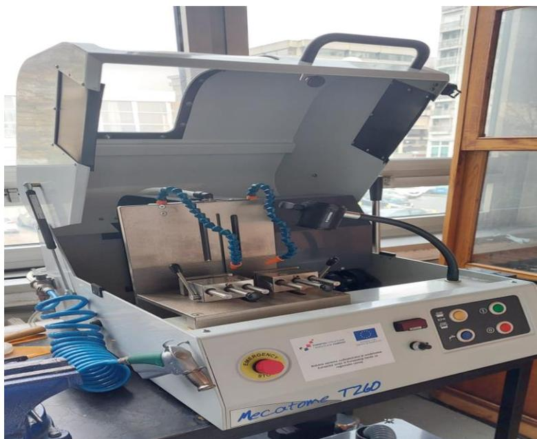
Slika 28. Uređaj za rezanje uzoraka
