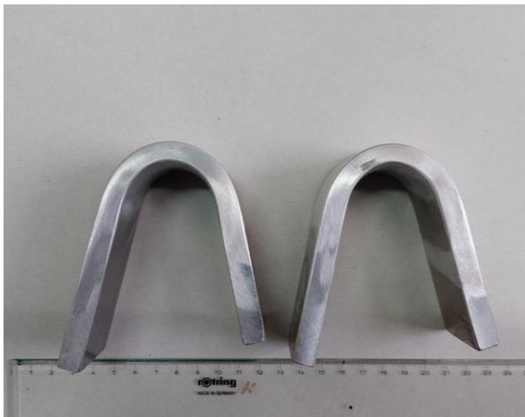
**Slika 56. Poprečni presjek zavarenog spoja nakon savijanja**
