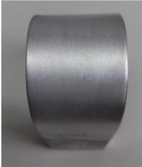
**Slika 55. Prikaz zavarenog spoja nakon savijanja**
