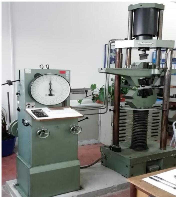
**Slika 52. Kidalica 30 TUZ 757 za mjerenje vlačne čvrstoće**
