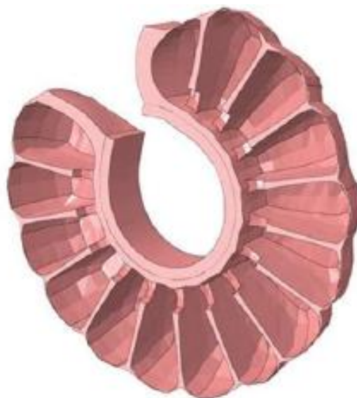
Slika 9. Akcija „sporog“ PneuNets aktuatora, [12]
