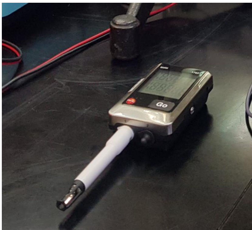
Slika 46. Mjerilo apsolutnog tlaka, temperature i vlažnosti zraka
