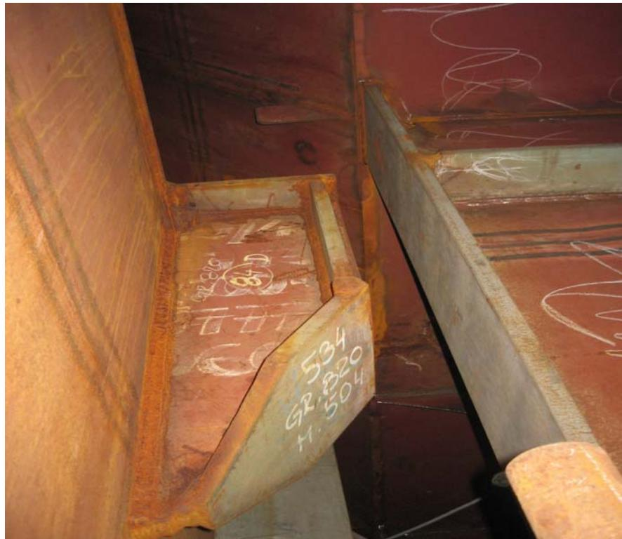
**Slika 25 Dio protunaplavnog ključa montiran na vertikalnom boku tanka tereta**
