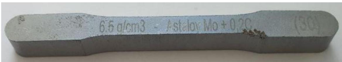
Slika 24. Epruveta od sinteriranog čelika Astaloy Mo+0,2C gustoće 6,5 g/cm<sup>3</sup>
