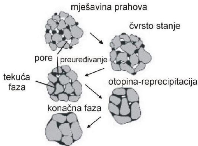
**Slika 9. Faze zgušnjavanja prilikom sinteriranja u tekućoj fazi [1]**
