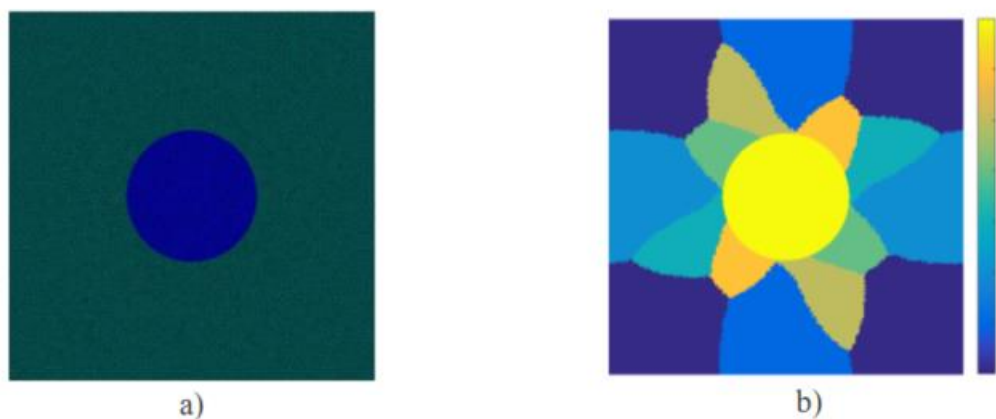
Slika 5.1. a) RVE diskretiziran s 10 000 trokutnih elemenata prvog reda, b) RVE diskretiziran s 8 klastera [14]
