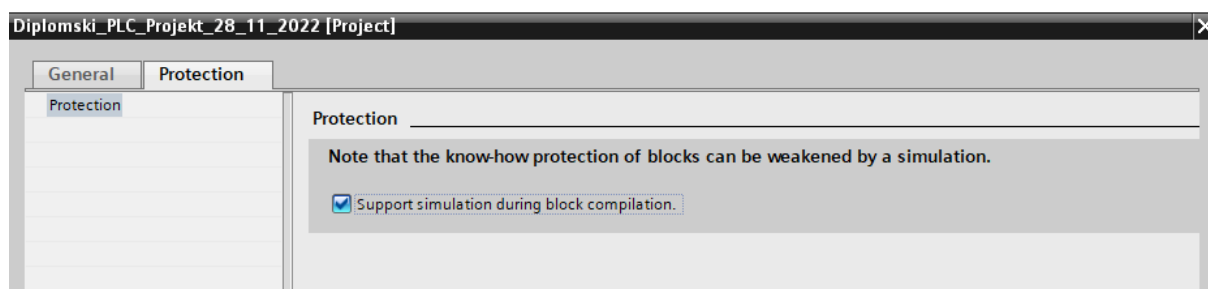
Slika 125. Podrška za PLC blokove unutar simulacije u postavkama PLC projekta unutar TIA Portal
