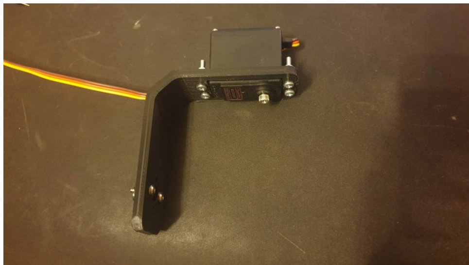
Slika 36 Spoj držača za servomotor i servomotora
