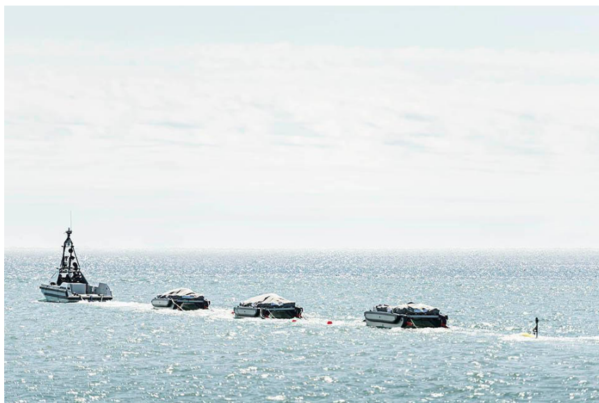
Slika 4. Autonomni sustav minolovaca kraljevske mornarice UK-a [8]
