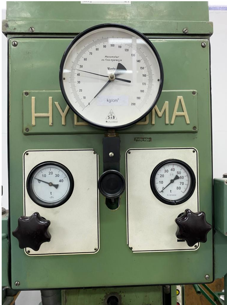
Slika 32. Mjerni instrumenti na hidrauličkoj preši
