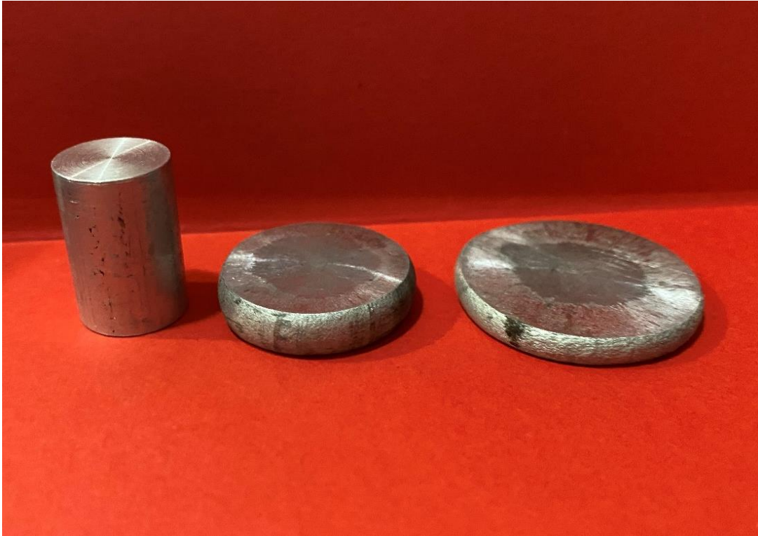
Slika 30. Valjčići tlačeni različitim silama kod preše
