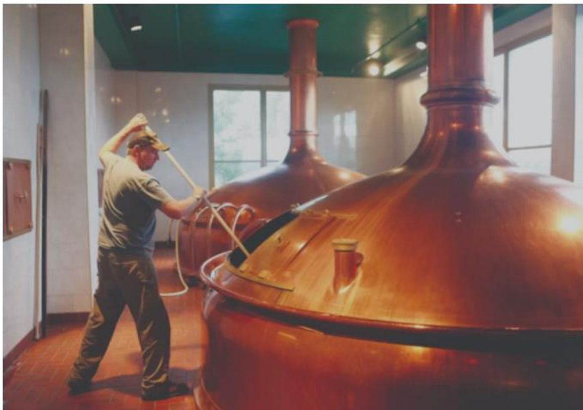
Slika 6. Kotlovi za kuhanje sladovine [3]
