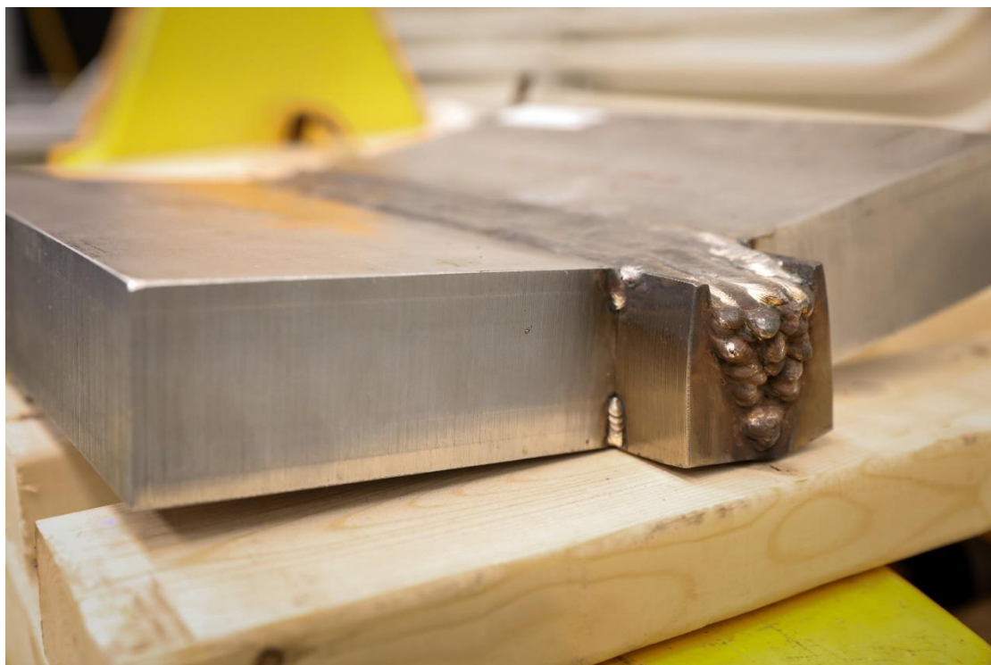
Slika 4. Deformacija nastala uslijed zavarivanja debelih ploča [18]
