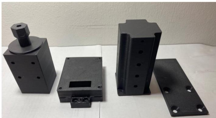
**Slika 7.2. Isprintane komponente za nefunkcionalni prototip obradne glave**
