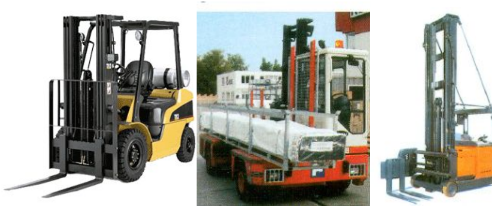
Slika 2.3. Izvedbe viličara – čelni, bočni i regalni
