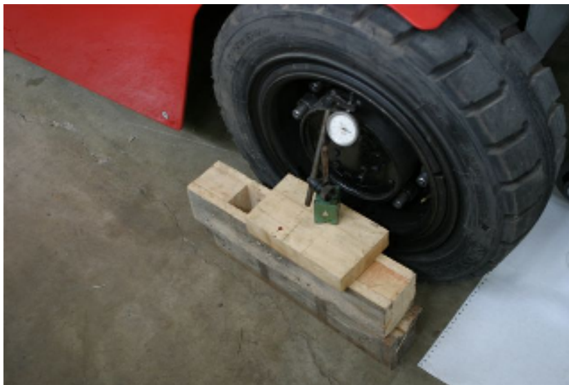
Slika 3.6. Postupak mjerenja statičkog progiba prednje gume viličara
