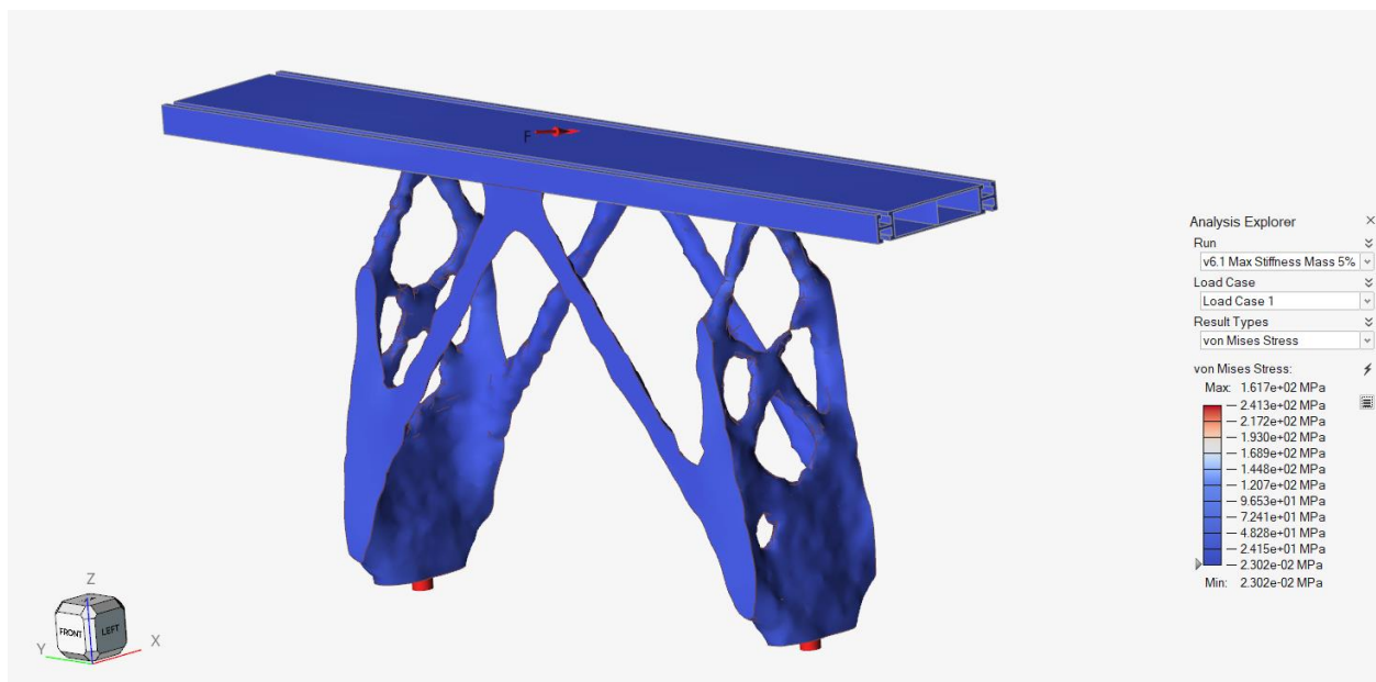
Slika 48: von Mises- Maksimiranje krutosti (5%)- smjer kretanja vlaka
