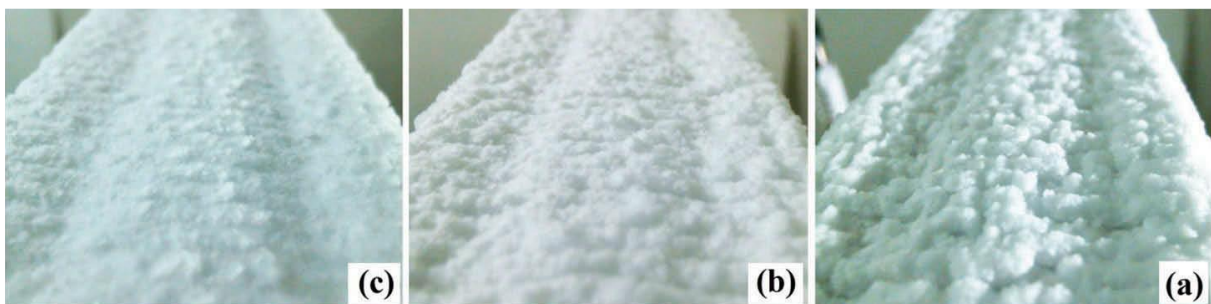
Slika 14 Usporedba strukture leda pri različitim temperaturama isparavanja [1]
