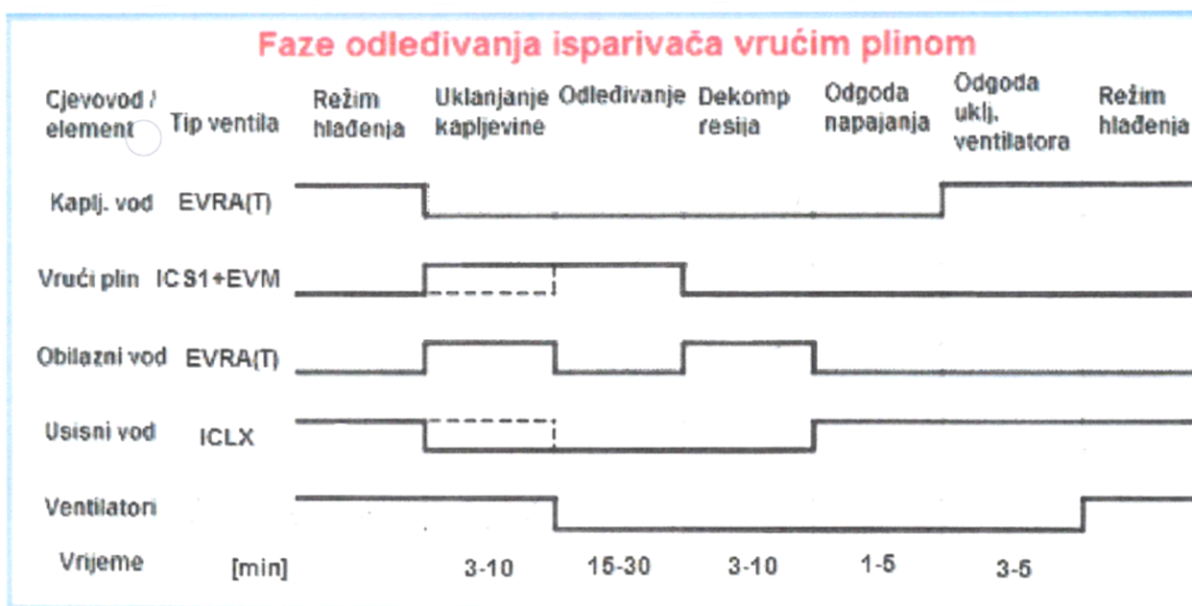
Slika 24 Prikaz faza odleđivanja isparivača vrućim plinom
