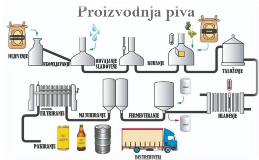
Slika 24 Postupak proizvodnje piva [35]
