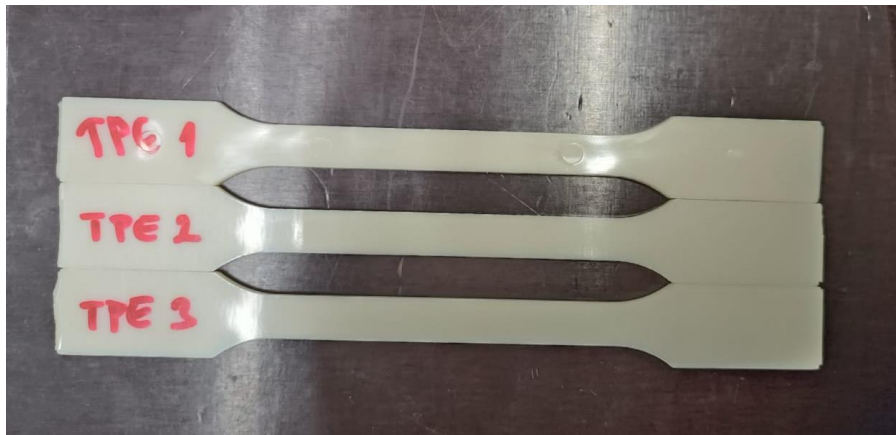
Slika 5.18. Ispitna tijela od elastoplastomernog materijala (TPE)
