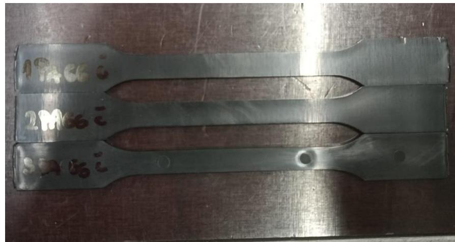
**Slika 5.16. Ispitna tijela od čistog poliamida (PA 66)**
