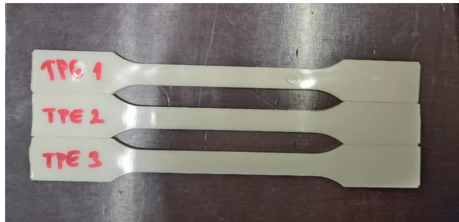
**Slika 5.18. Ispitna tijela od elastoplastomernog materijala (TPE)**
