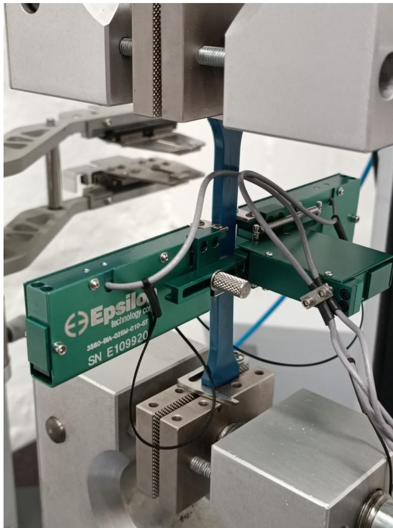
Slika 5.7. Uređaj za mjerenje poissonovog faktora marke Epsilon postavljen na poziciju prije početka mjerenja
