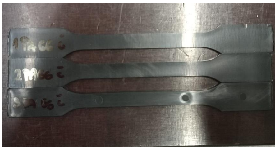
Slika 5.16. Ispitna tijela od čistog poliamida (PA 66)
