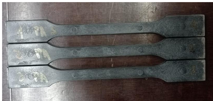
Slika 5.14. Ispitna tijela poliamida (PA) ojačanog s 33% staklenih vlakana
