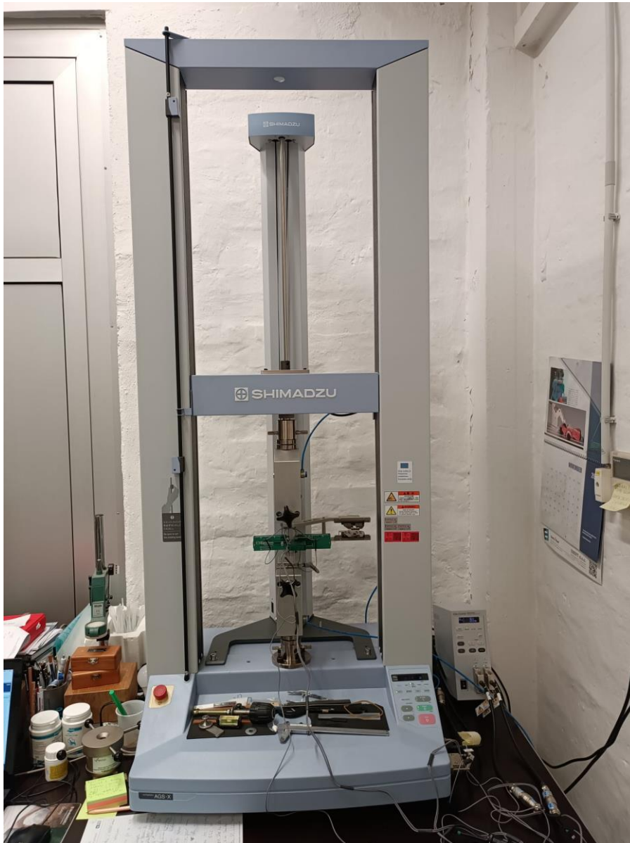
Slika 5.6. Kidalica Shimadzu AGS - x na kojoj su provedena ispitivanja
