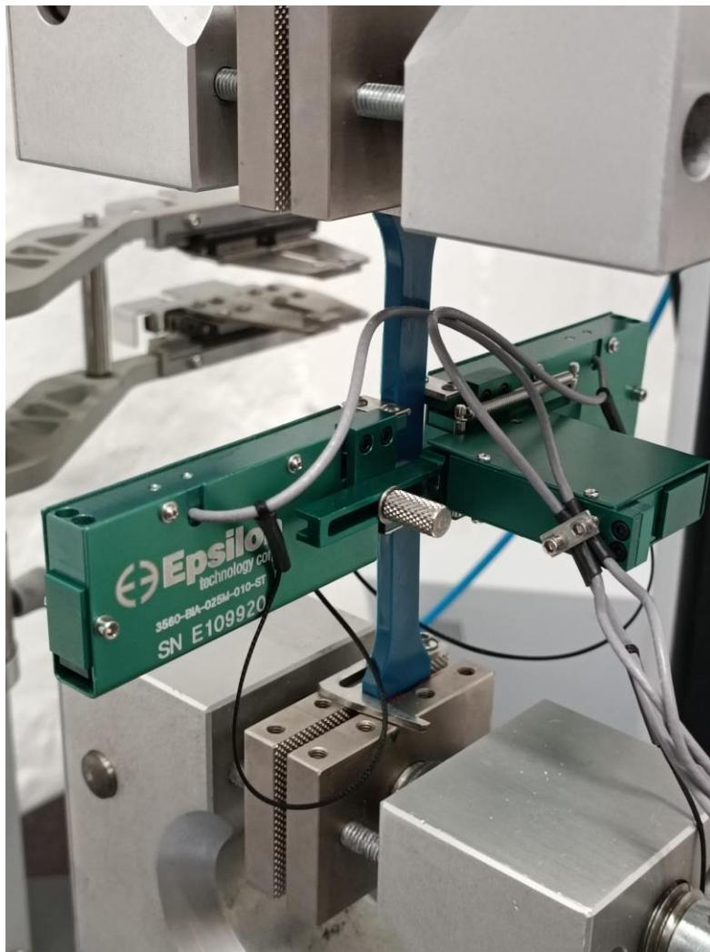
**Slika 5.7. Uređaj za mjerjenje poissonovog faktora marke *Epsilon* postavljen na poziciju prije početka mjerena**
