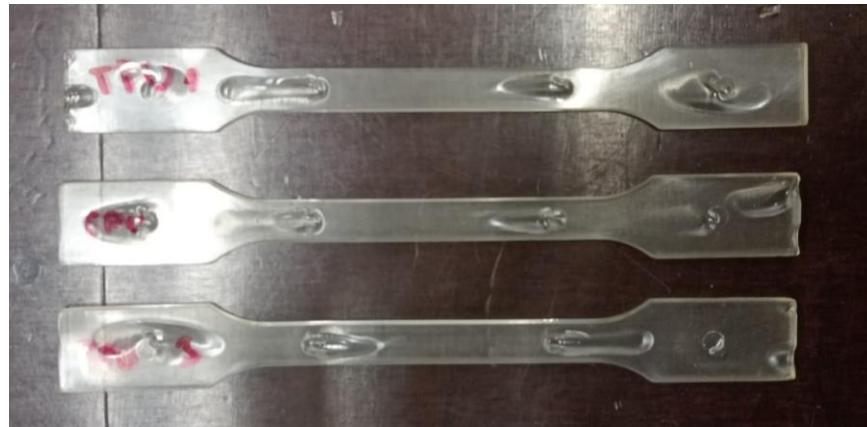
**Slika 5.19. Ispitna tijela od poliuretanskog elastomera (TPU)**
