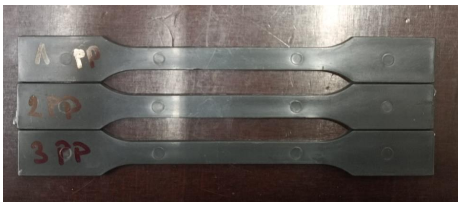
Slika 5.17. ispitna tijela od polipropilena (PP)
