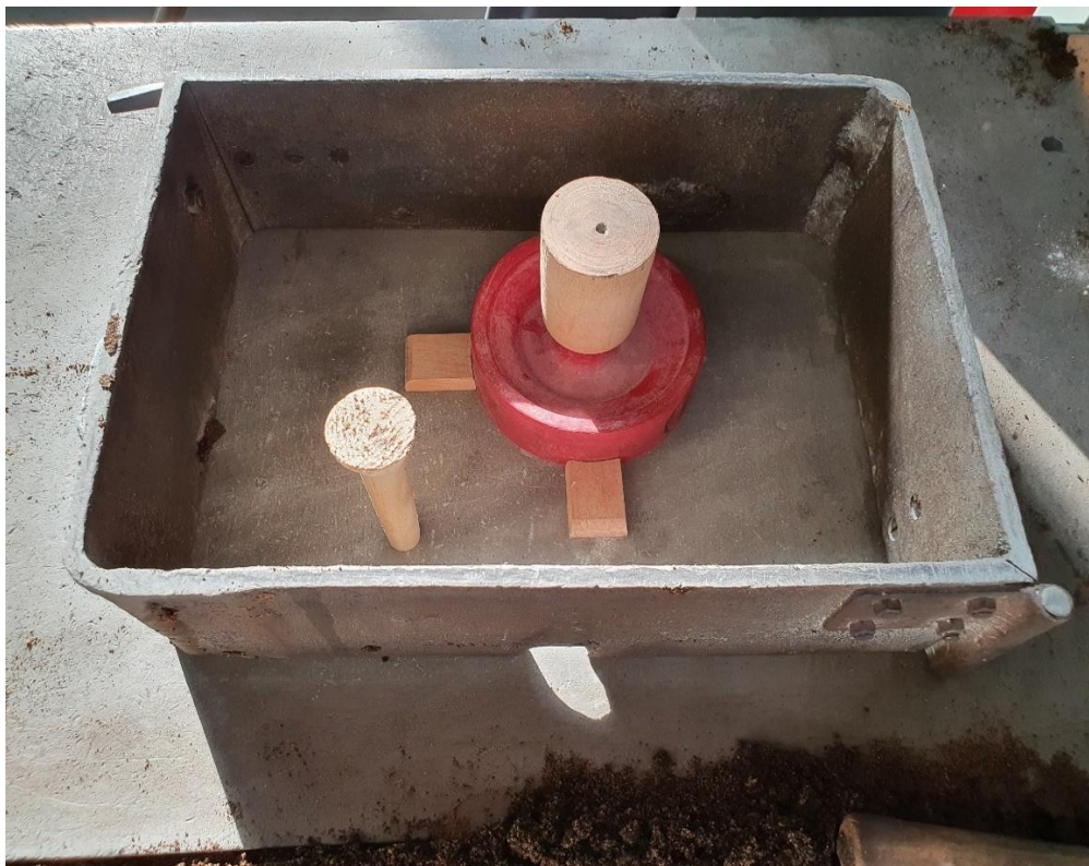
Slika 55. Pozicioniranje modela Varijante 2 u gornjaku
