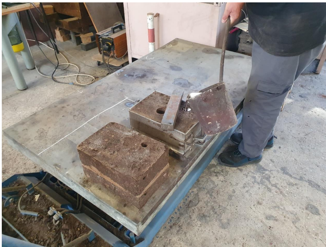
Slika 66. Lijevanje horizontalnih varijanti uljevnih sustava
