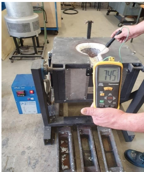
Slika 63. Temperatura taline u peći
