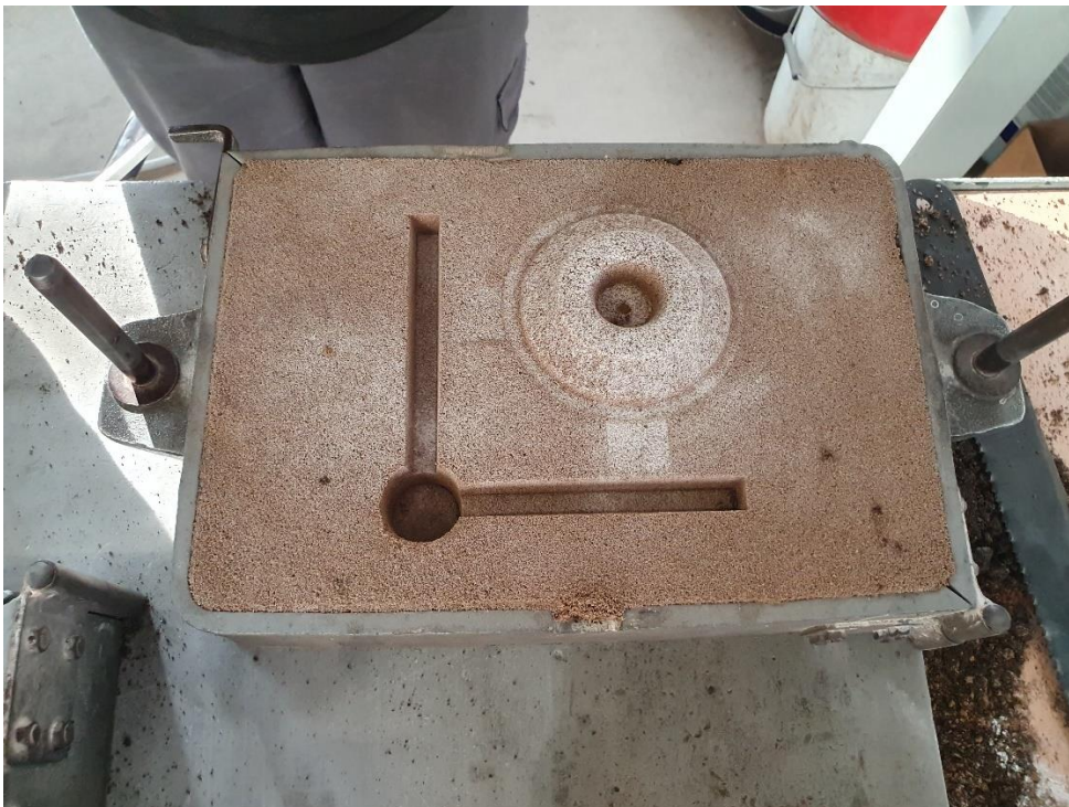
Slika 62. Izgled kalupne šupljine Varijante 2 u donjaku
