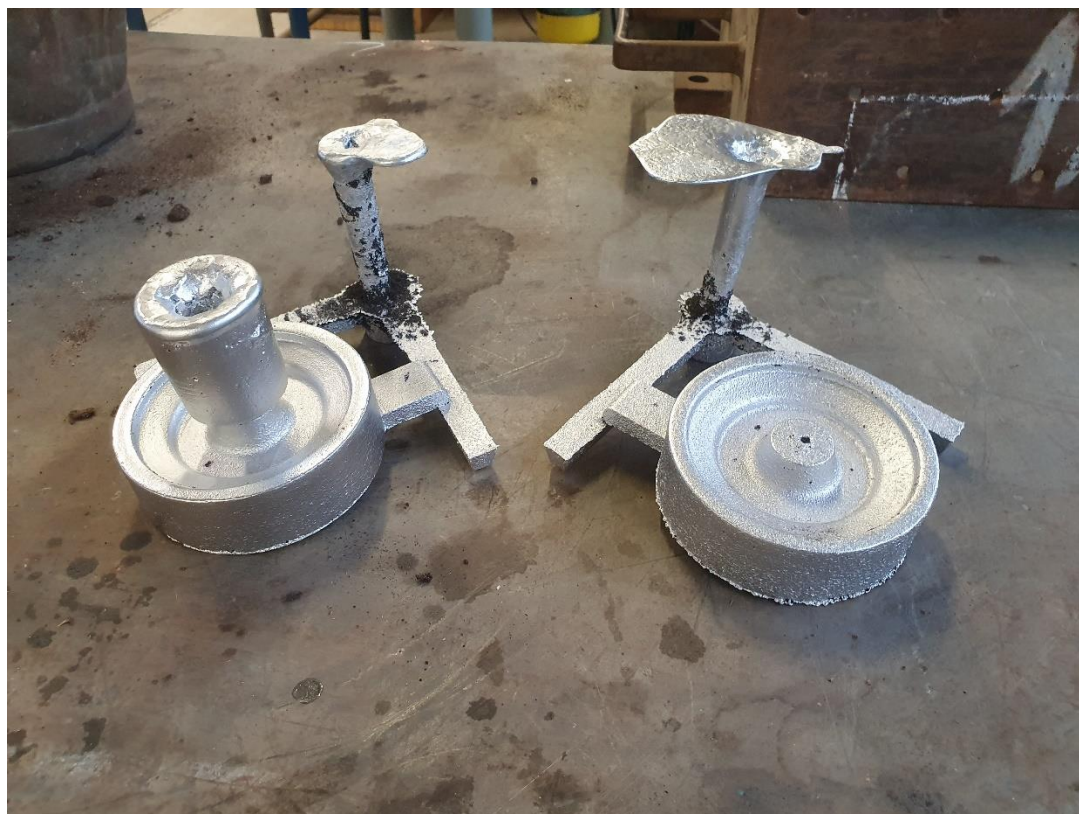
Slika 69. Izgled odljevka horizontalnih varijanti uljavnog sustava nakon hlađenja
