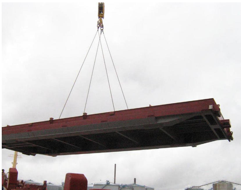
Slika 2.1 Podizni grotleni poklopac [5]
