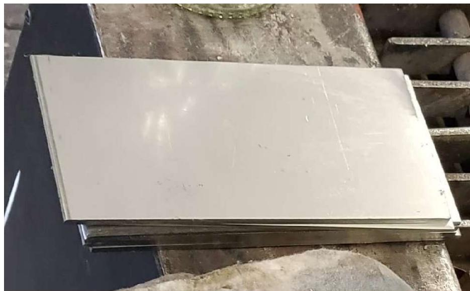
Slika 31. Ploče od nehrđajućeg čelika 1.4301
