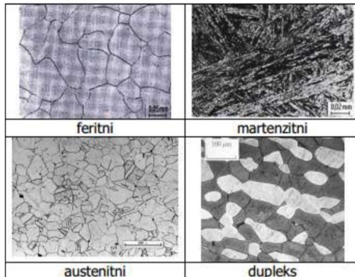
Slika 1. Podjela nehrđajućih čelika prema mikrostrukturi [4]
