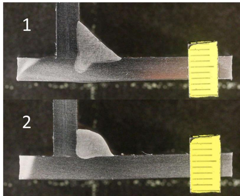
Slika 48. Geometrija zavara uzorka 1 i 2
