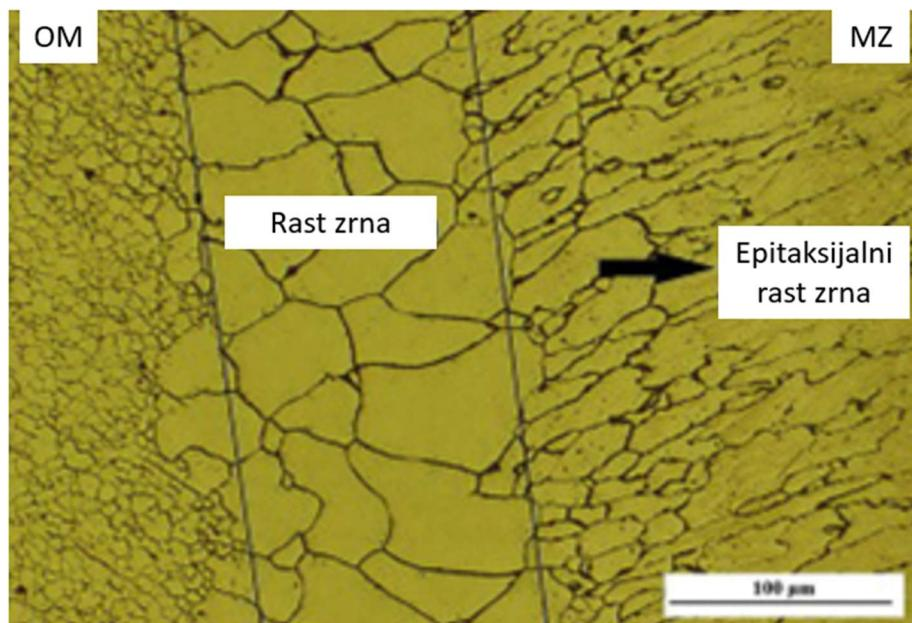
Slika 19. Epitaksijalni rast zrna uslijed zavarivanja čelika 1.4845 [12]
