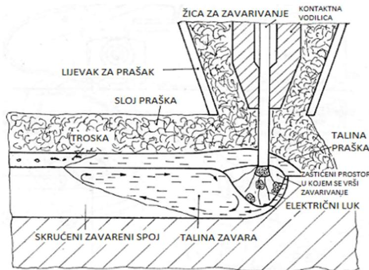
Slika 25. Shematski prikaz EPP postupka zavarivanja [20]
