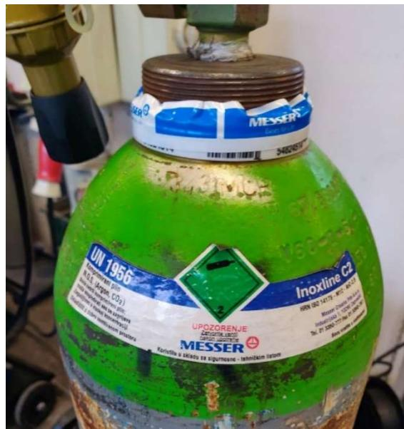
Slika 33. Spremnik plinske mješavine Inoxline C2
