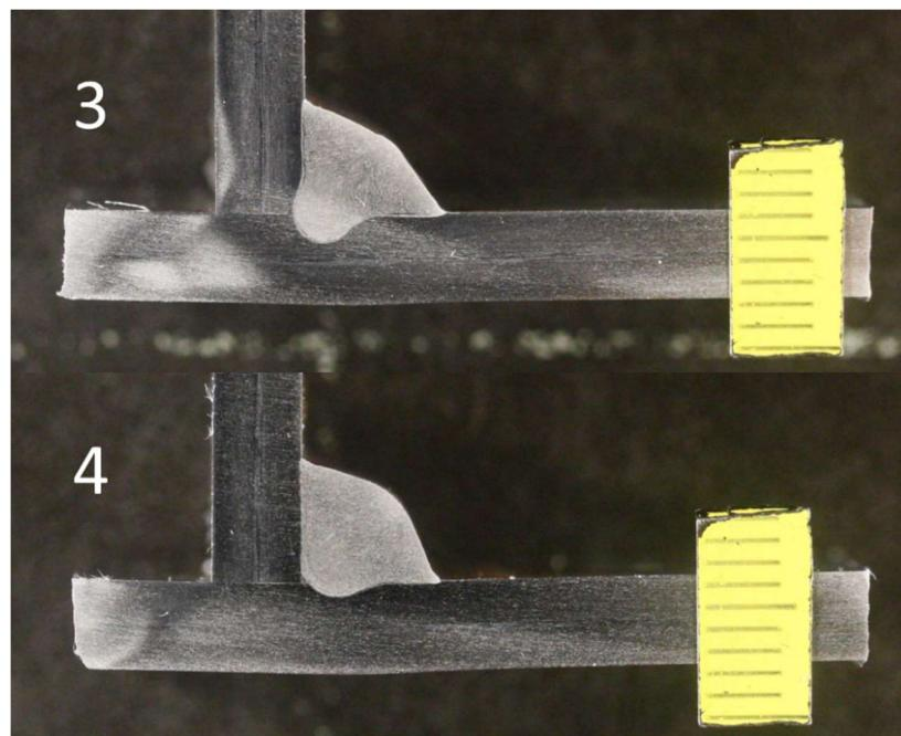
Slika 49. Geometrija zavara uzoraka 3 i 4
