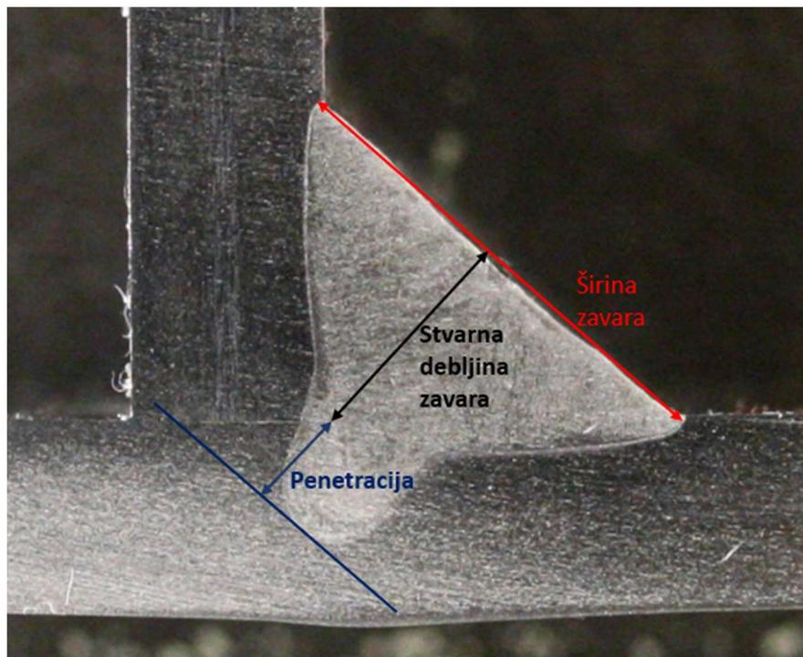
Slika 52. Prikaz kotiranih veličina: stvarne debljine zavara, penetracije i širine zavara
