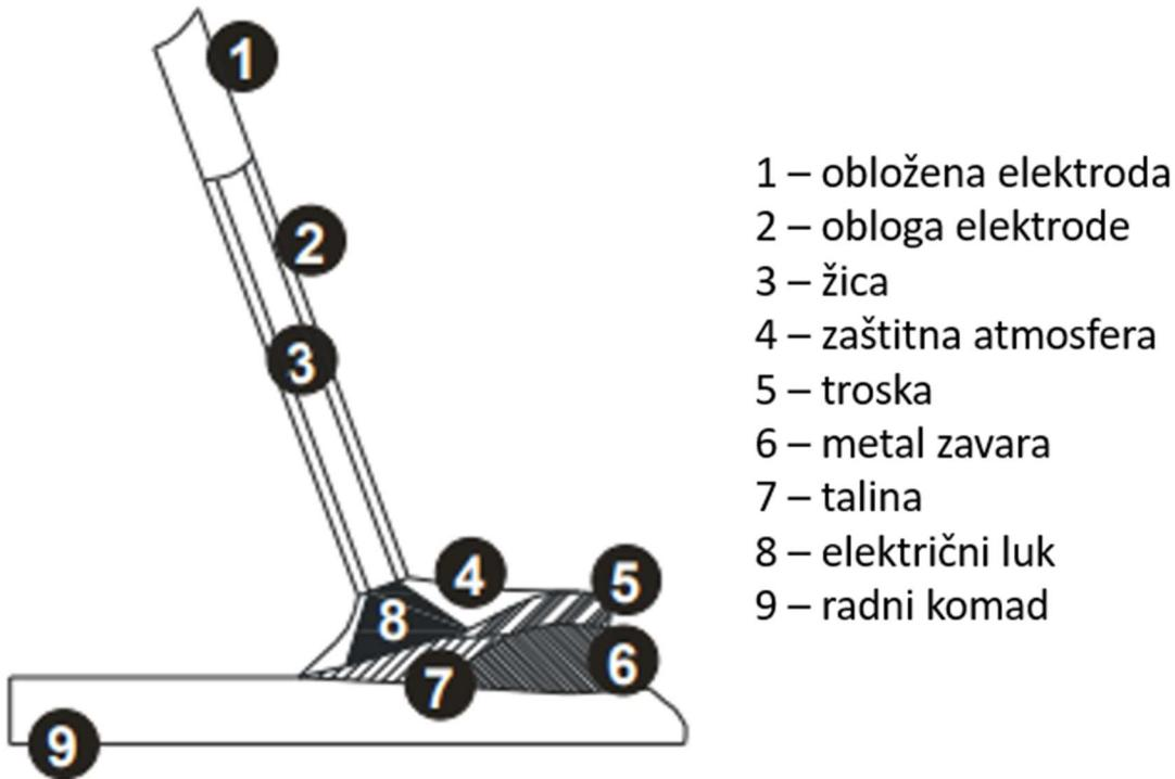
Slika 20. Shematski prikaz REL postupka zavarivanja [13]
