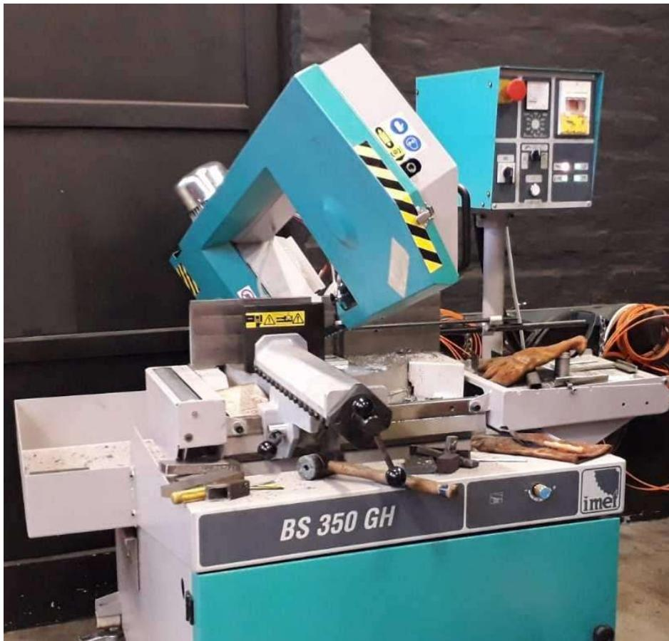
Slika 43. Tračna pila „BS 350 GH“
