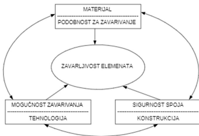
Slika 11. Zavarljivost metalnih materijala [8]
