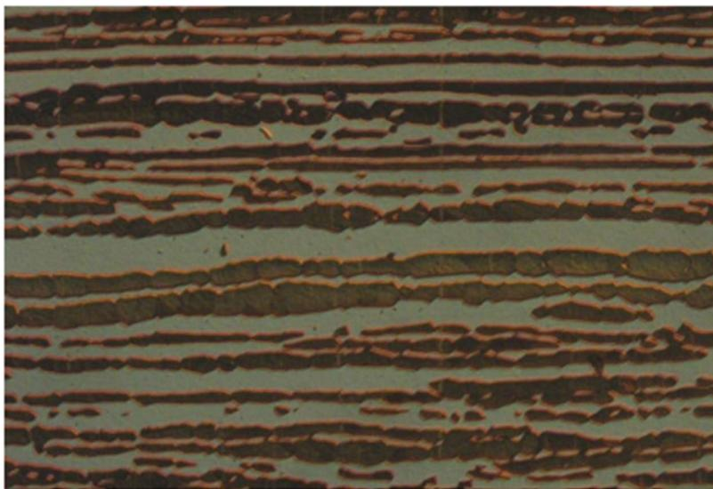
Slika 10. Mikrostruktura dupleks čelika [1]
