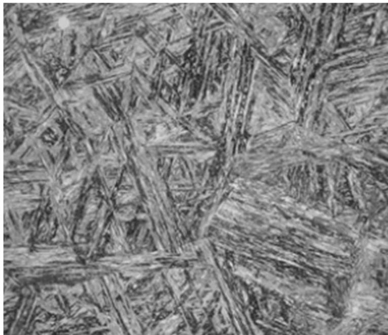
Slika 6. Mikrostruktura martenzitnog čelika [1]
