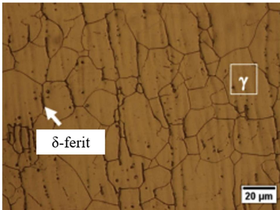
Slika 15. Mikrostruktura austenitnog čelika s delta-feritom [12]
