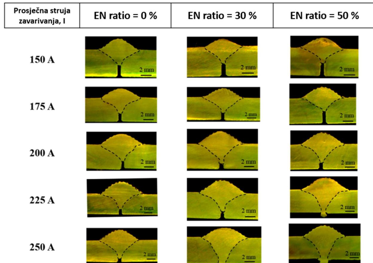
Slika 29. Geometrija zavara ovisno o jakosti struje zavarivanja i EN omjeru [25]
