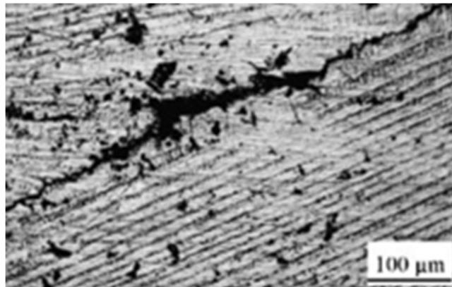
Slika 18. Vruća pukotina nastala skrućivanjem u mikrostrukturi čelika 1.4845 [12]
