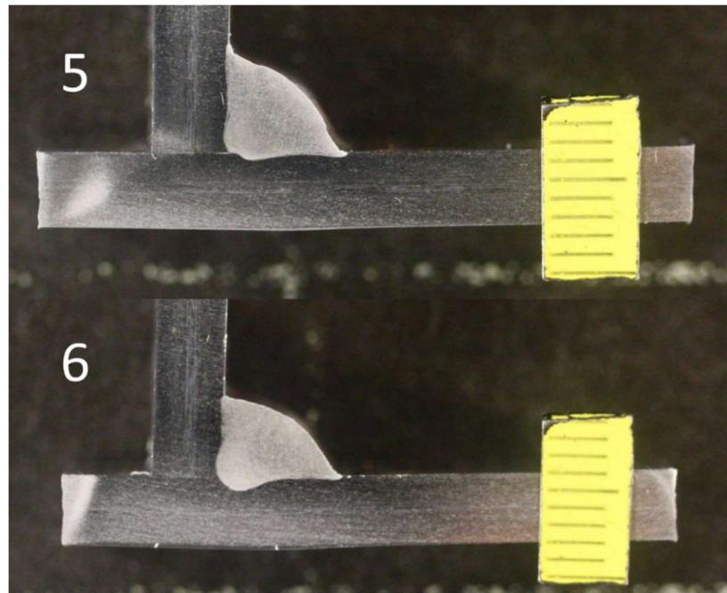
Slika 50. Geometrija zavara uzoraka 5 i 6
