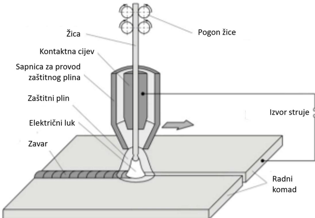
Slika 22. Shematski prikaz MIG/MAG postupka zavarivanja [3]
