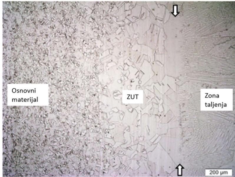
Slika 13. Mikrostruktura u područjima zavara [9]
