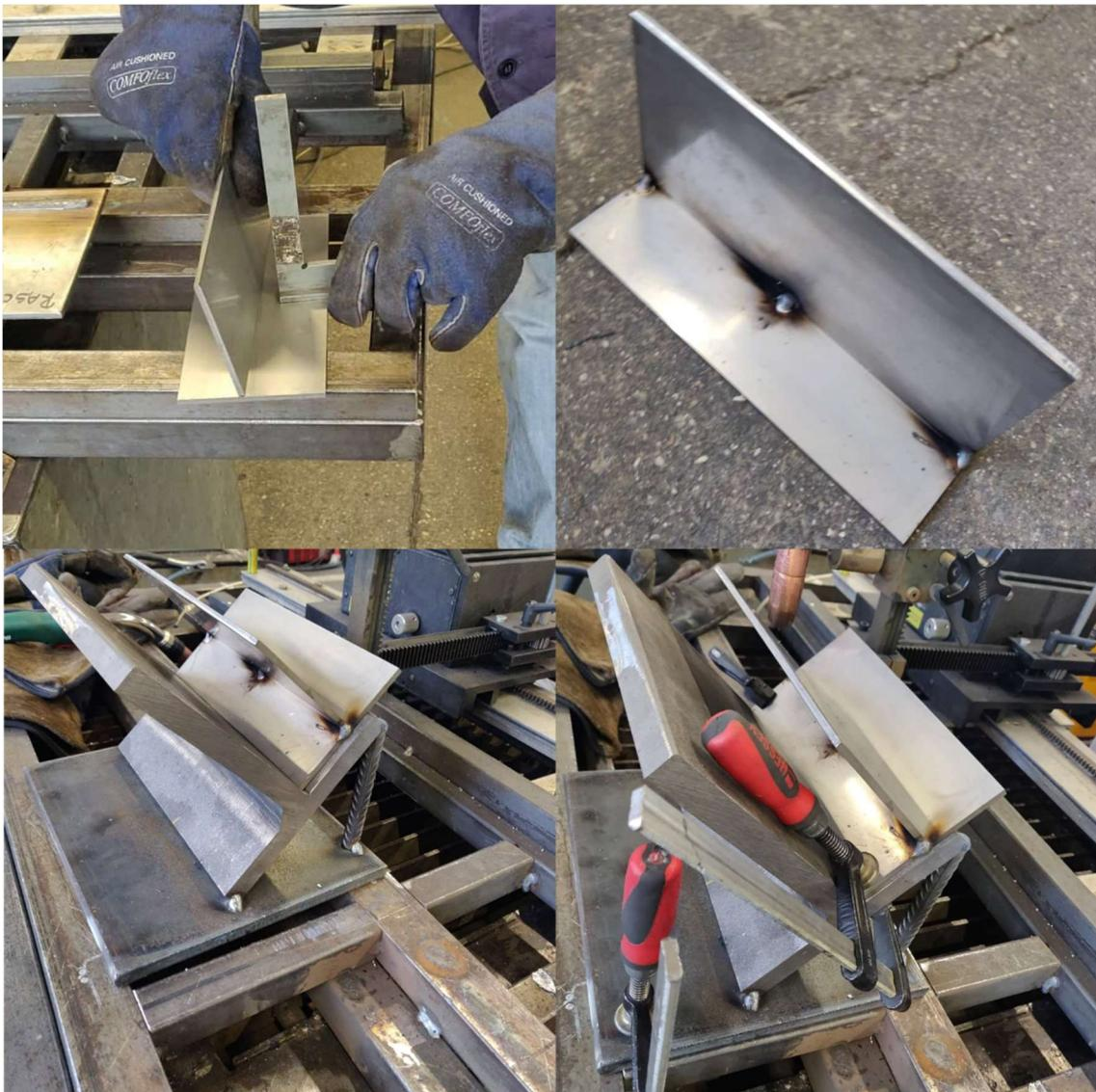
Slika 36. Priprema uzoraka za zavarivanje
