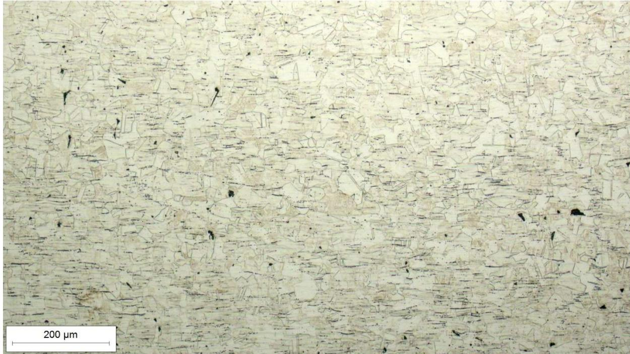
Slika 55. Mikrostruktura osnovnog materijala 1.4301 (AISI 304)
