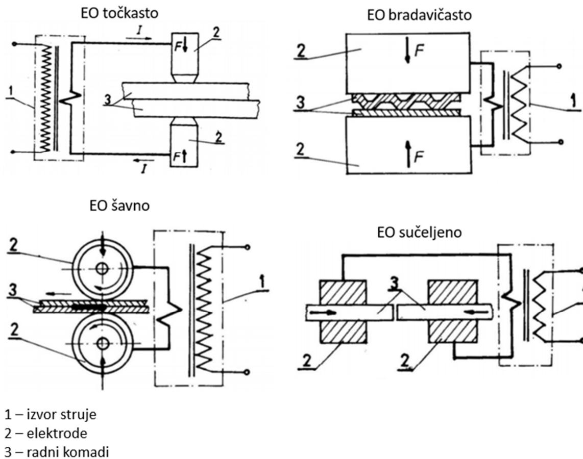
Slika 26. Shematski prikaz elektrootpornih postupaka zavarivanja [21]
