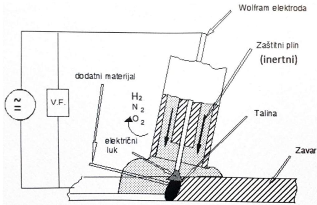
Slika 21. Shematski prikaz TIG postupka zavarivanja [2]
