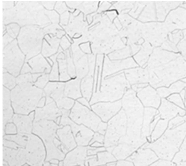
Slika 7. Mikrostruktura austenitnog čelika [1]
