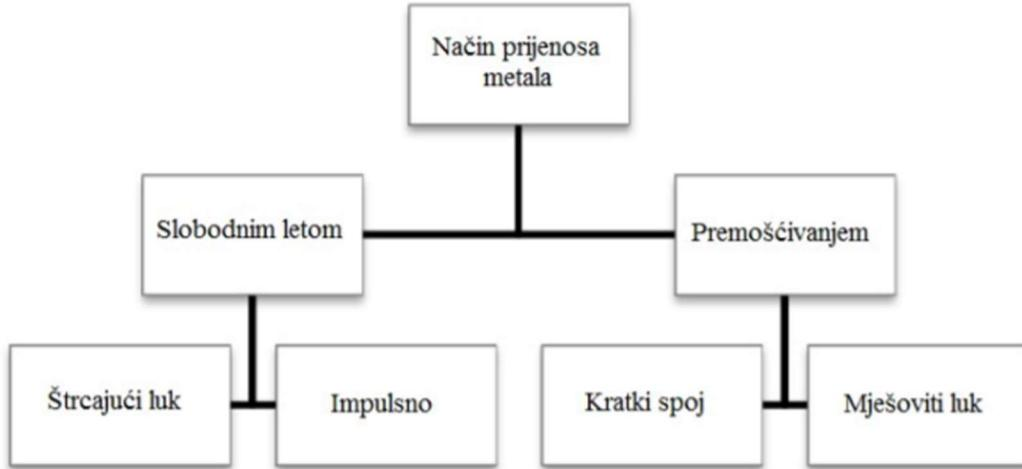
Slika 23. Načini prijenosa metala MIG/MAG postupkom zavarivanja [19]
