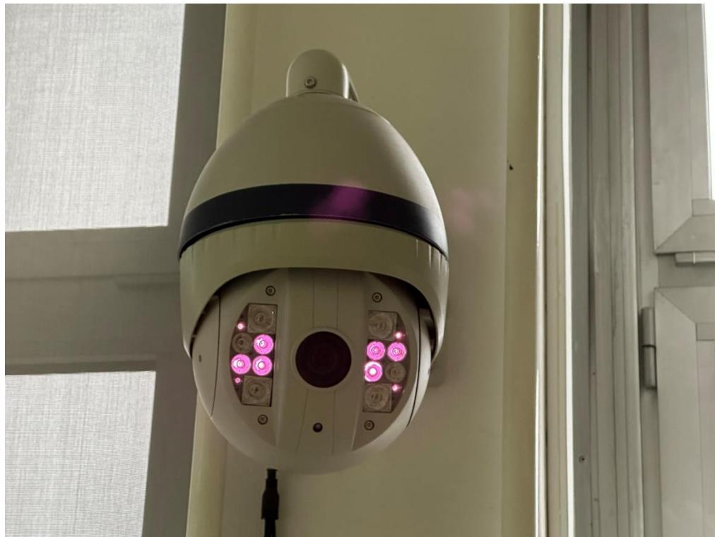
Slika 37. IR LAN kamera s optičkim zumiranjem
