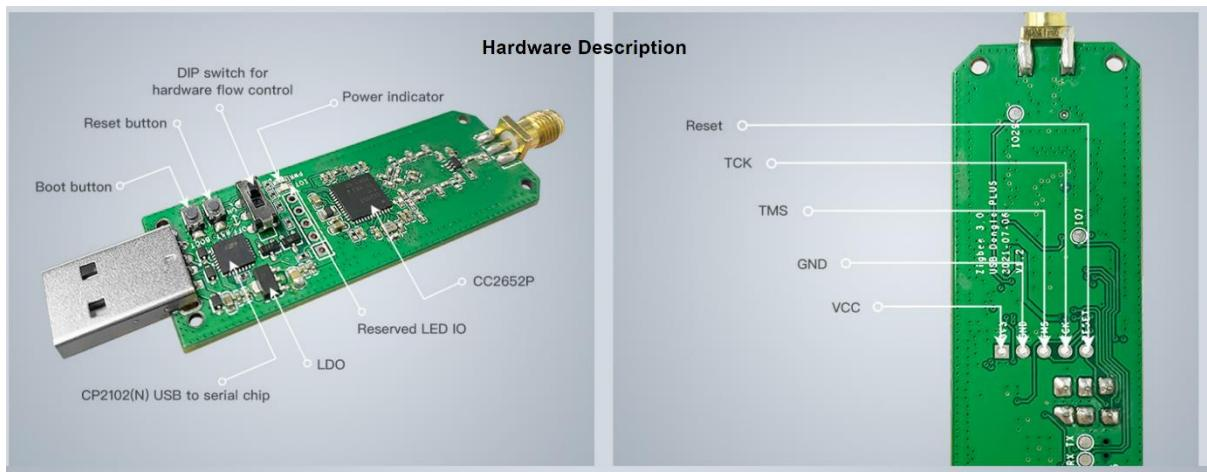
**Slika 28. Zigbee dongle**
