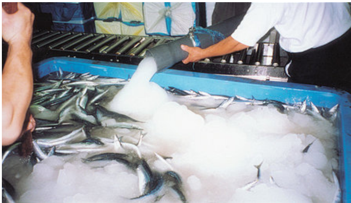
Slika 15. Sipanje tekućeg leda u posudu s ribom [20]
