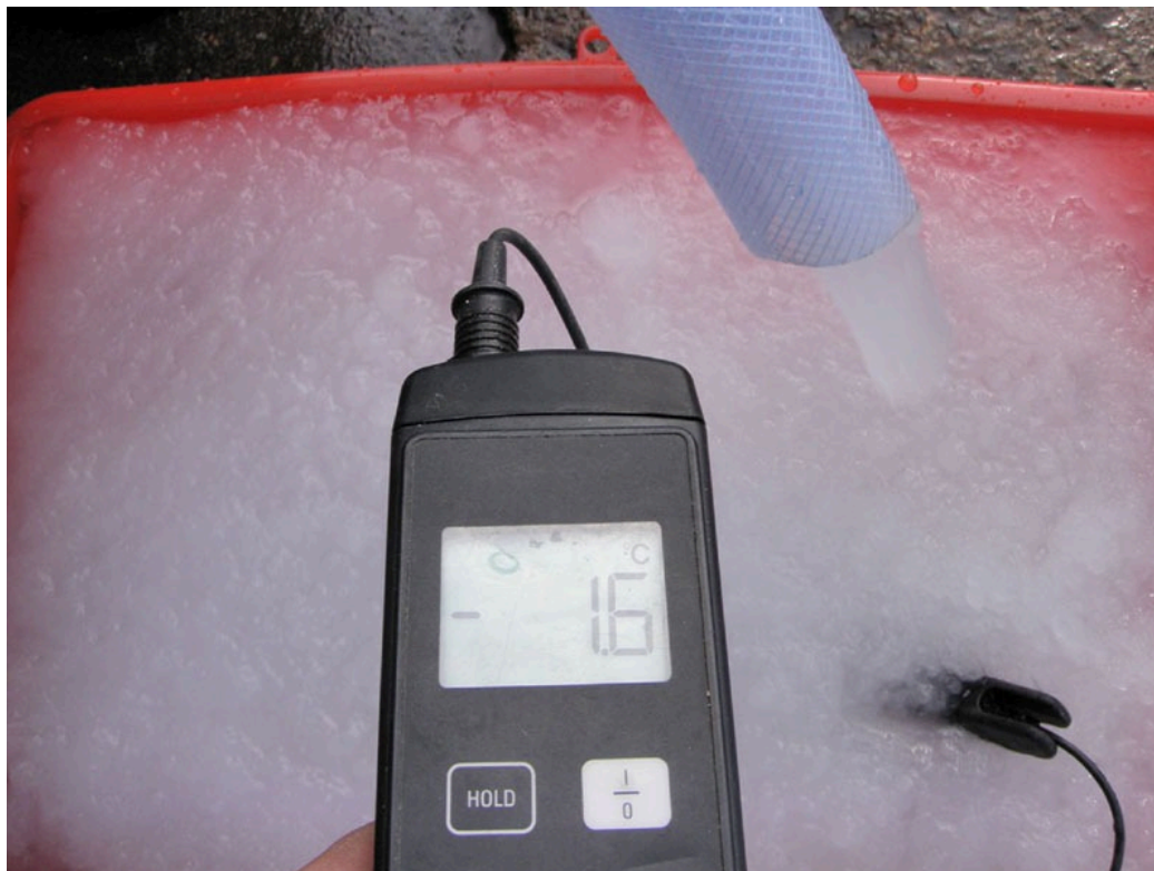
Slika 17. Konzistentnost tekućeg leda pri temperaturi -1,6 °C [21]
