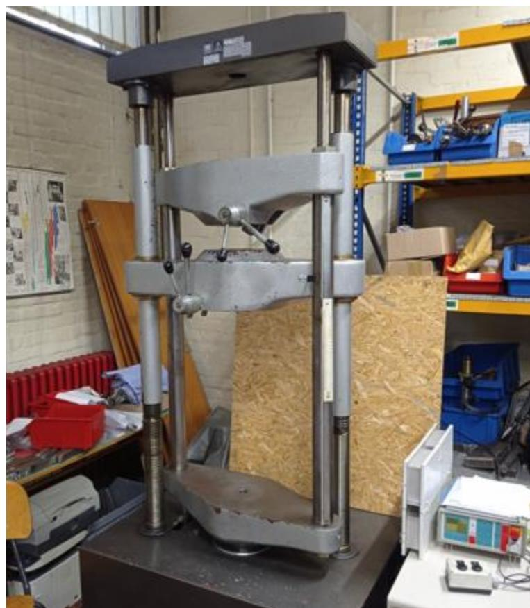
Slika 32. Hidraulička kidalica
