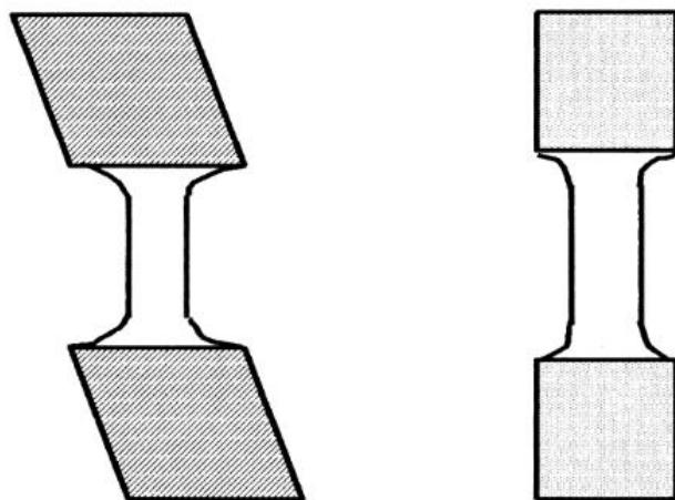
Slika 19. Nepravilno i pravilno izvedena epruveta [4]
