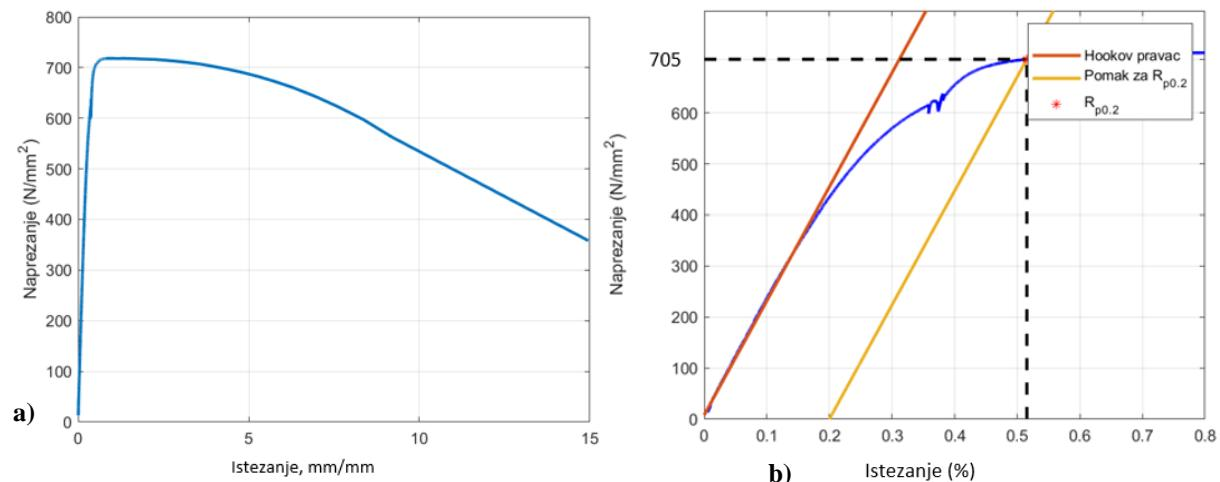
Slika 39.  $\sigma - \varepsilon$  dijagram (a) s istaknutim područjem elastičnosti (b) za frekvenciju ispitivanja 50 Hz, čelik 50CrV4
