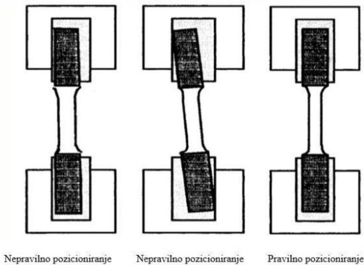
**Slika 14.** Pravilno i nepravilno postavljanje epruvete [4]
