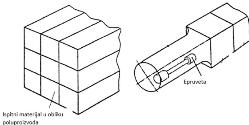
**Slika 15. Izrada epruveta mehaničkom obradom iz poluproizvoda [4]**
