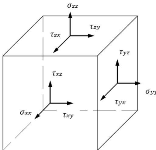
Slika 1. Komponente naprezanja kockastog čvrstog tijela [2]
