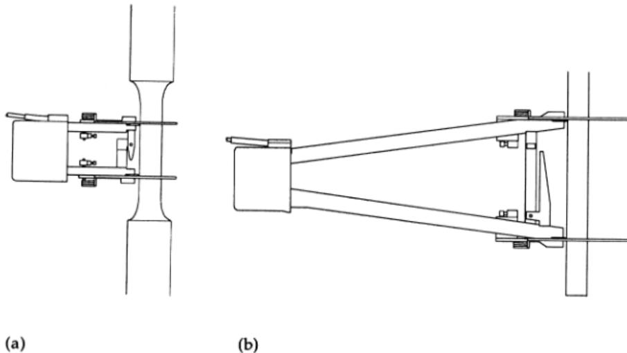
**Slika 8.** Vrste kontaktnih ekstenzometara: a) ekstenzometar s mjernom duljinom od 25 mm i hodom od 3,75 mm prikladan za statička i dinamička ispitivanja; b) ekstenzometar s mjernom duljinom od 50 mm i hodom od 25 mm pogodan za velike uzorke i materijale s velikim istezanjem [4]
