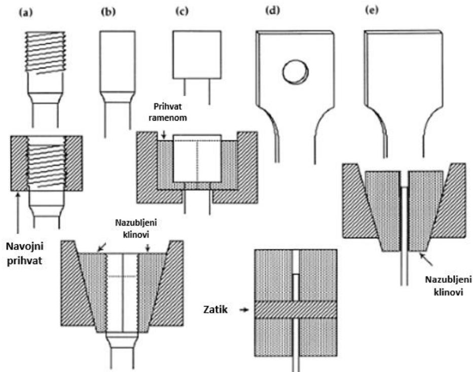
**Slika 13.** Izvedba glave epruvete: a) prihvat pomoću navoja, b) prihvat pomoću nazubljenih klinova, c) prihvat ramanom, d) prihvat pomoću zatika i e) prihvat tankih epruveta pomoću nazubljenih klinova [4]
