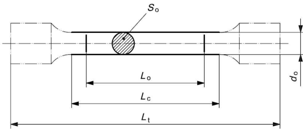
Slika 17. Epruveta kružnog poprečnog presjeka [5]
