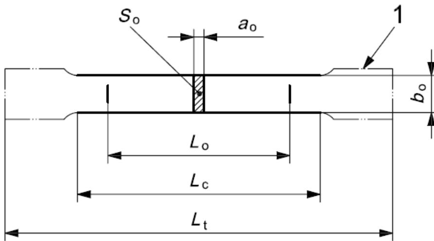
Slika 18. Epruveta pravokutnog poprečnog presjeka [5]
