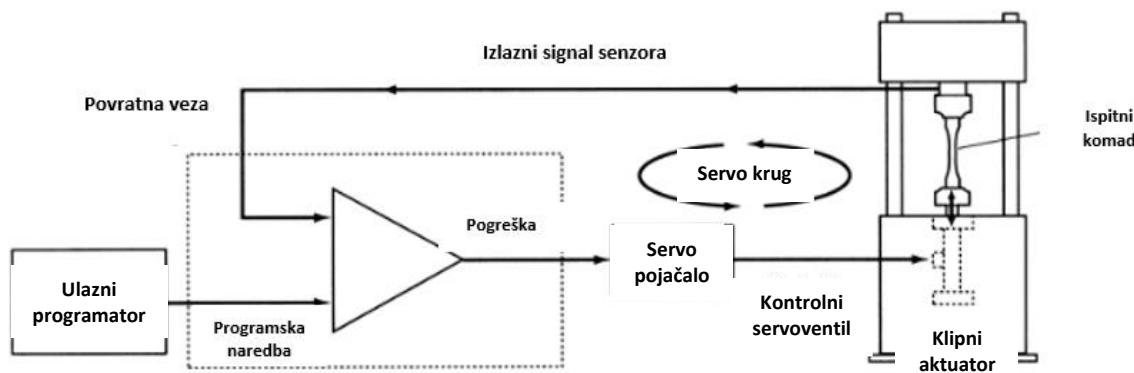
Slika 5. Shematski prikaz zatvorenog kruga servohidrauličnog mehanizma [4]
