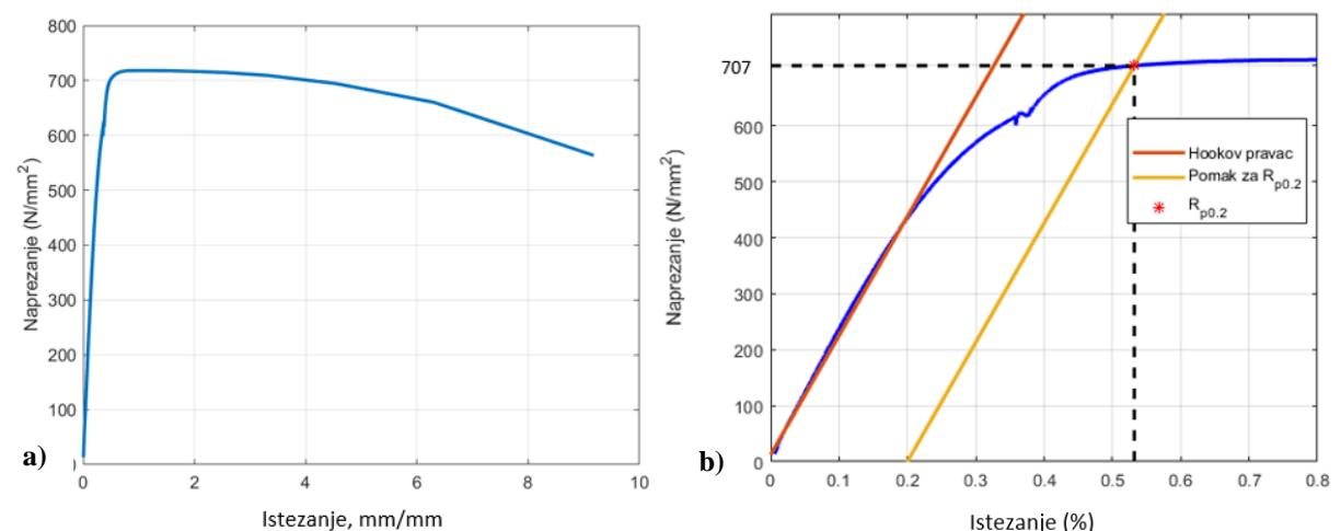
**Slika 36.**  $\sigma - \varepsilon$  dijagram (a) s istaknutim područjem elastičnosti (b) za frekvenciju ispitivanja 5 Hz, čelik 50CrV4
