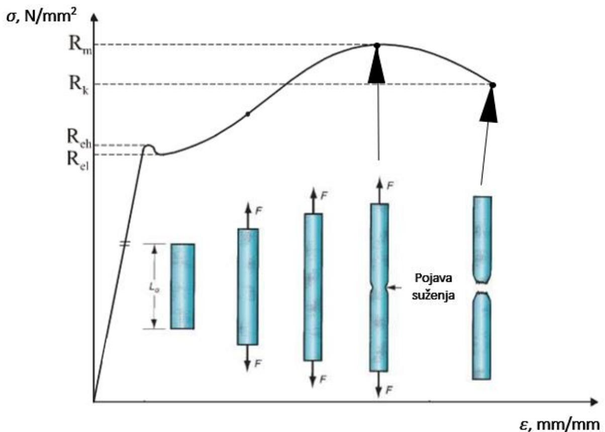
**Slika 26.** Različiti stadiji epruvete prilikom statičkog vlačnog ispitivanja [2, 6]
