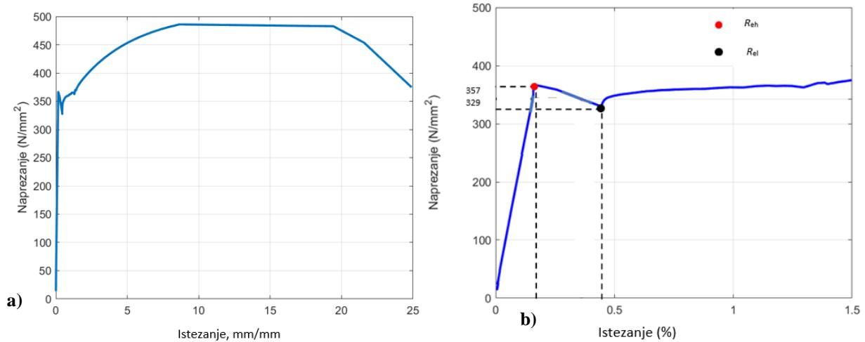
**Slika 41.**  $\sigma - \varepsilon$  dijagram (a) s istaknutim područjem elastičnosti (b) za frekvenciju ispitivanja 5 Hz, čelik C15E
