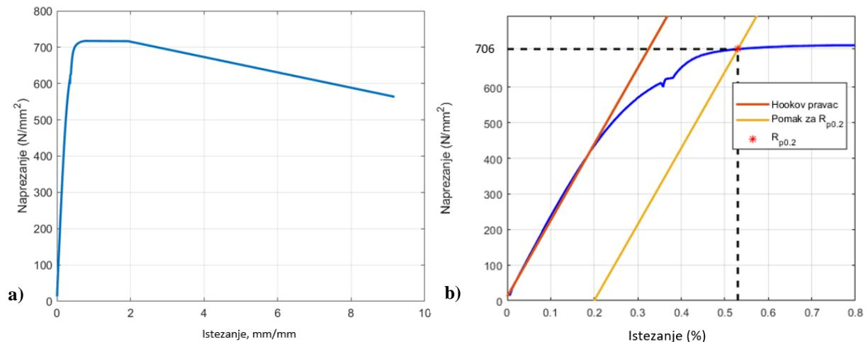
**Slika 35.**  $\sigma - \varepsilon$  dijagram (a) s istaknutim područjem elastičnosti (b) za frekvenciju ispitivanja 1 Hz, čelik 50CrV4
