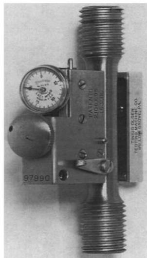
**Slika 9.** Analogni ekstenzometar [4]
