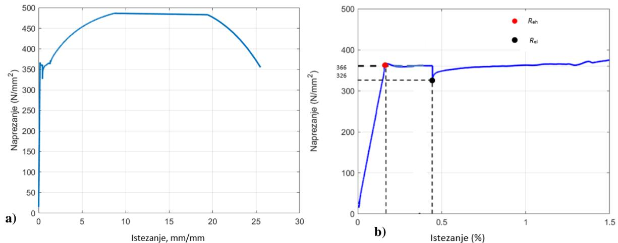
**Slika 43.**  $\sigma - \varepsilon$  dijagram (a) s istaknutim područjem elastičnosti (b) za frekvenciju ispitivanja 20 Hz, čelik C15E
