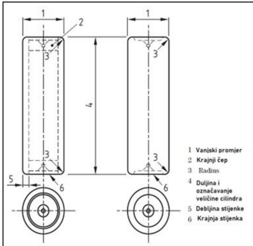
Slika 7 Cilindrični etalon pravog kuta [8]
