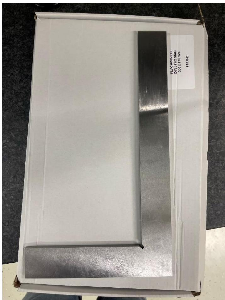
Slika 23 Čelični kutnik Flackwinkel DIN 875/2
