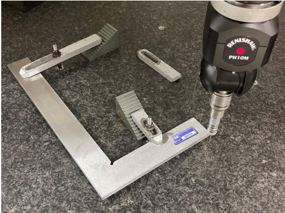
Slika 45 Način pričvršćivanja čeličnog kutnika na CMM-u
