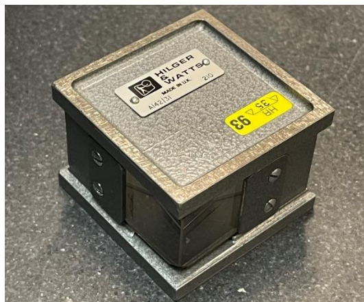
Slika 15 Etalon pravog kuta (lab. oznaka KUT 27-556)
