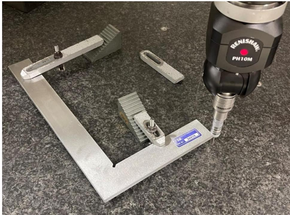
Slika 45 Način pričvršćivanja čeličnog kutnika na CMM-u
