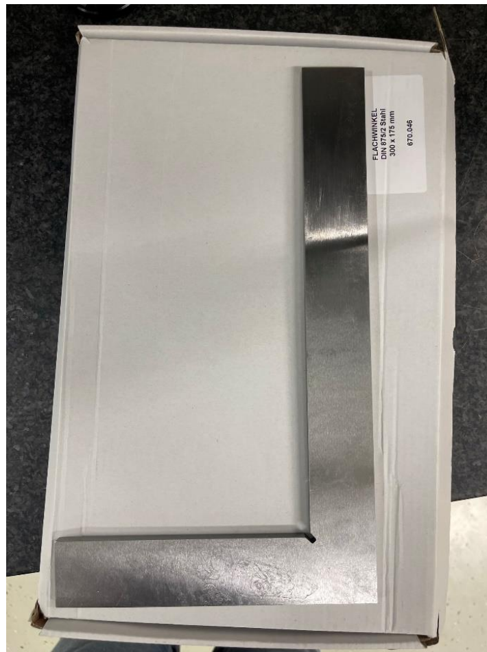
Slika 23 Čelični kutnik Flachwinkel DIN 875/2
