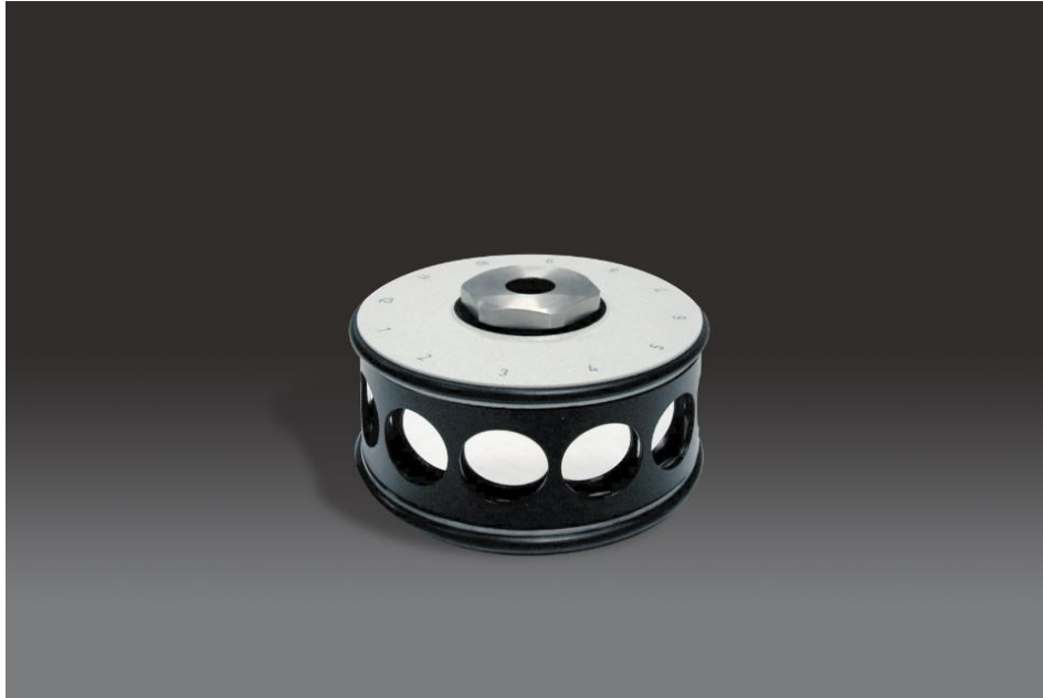
Slika 13 Kutni optički poligon [15]
