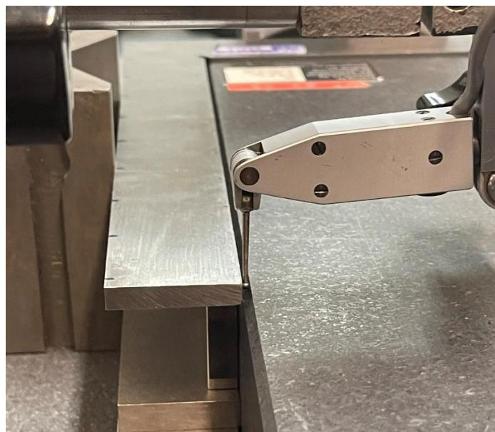
Slika 42 Mjerenje unutarnjeg kuta čeličnog kutnika
