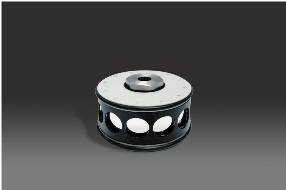
Slika 13 Kutni optički poligon [15]
