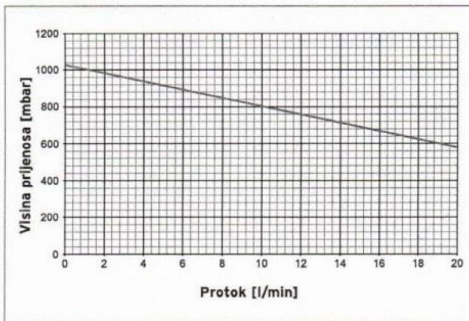
Slika 36. Radna krivulja solarne crpke „VMS 70“ [25]
