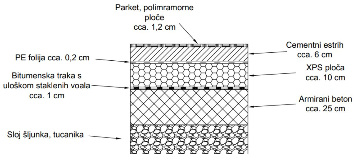
**Slika 9. Slojevi poda na tlu s podnim grijanjem**
