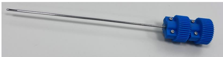
Slika 90. Montaža gonjenih zupčanika 1 i 2 na biopsijsku sondu
