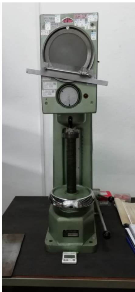
Slika 54 Uredaj za ispitivanje tvrdoće HV10
