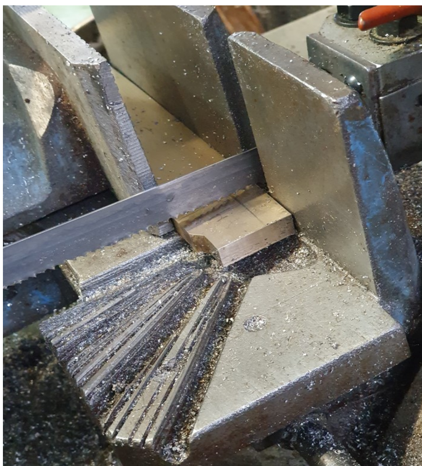
Slika 27 Rezanje uzorka pilom
