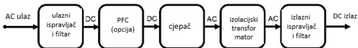
Slika 31. Shema ispravljača AC/DC[26]
