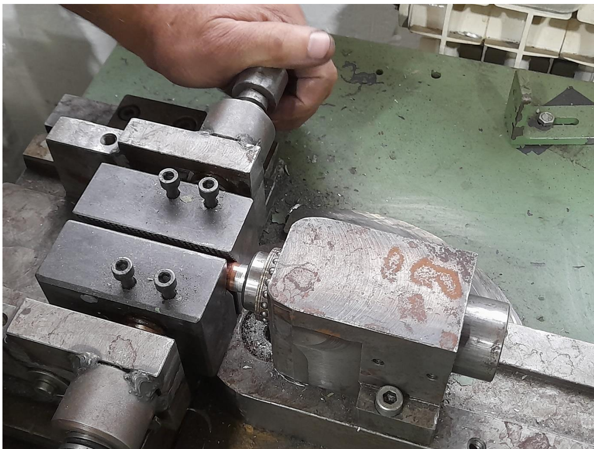
Slika 55. Ispitivanje spoja na stolnoj kidalici
