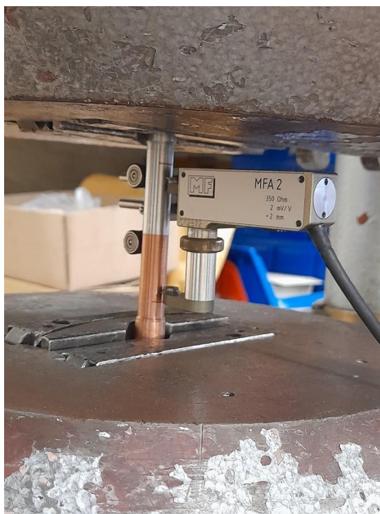
Slika 61. Montirana ispitna epruveta spremna na vlačni test
