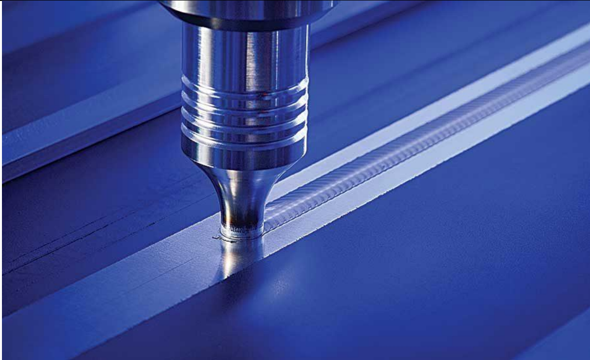
Slika 13. Zavarivanje trenjem rotirajućim alatom [10]
