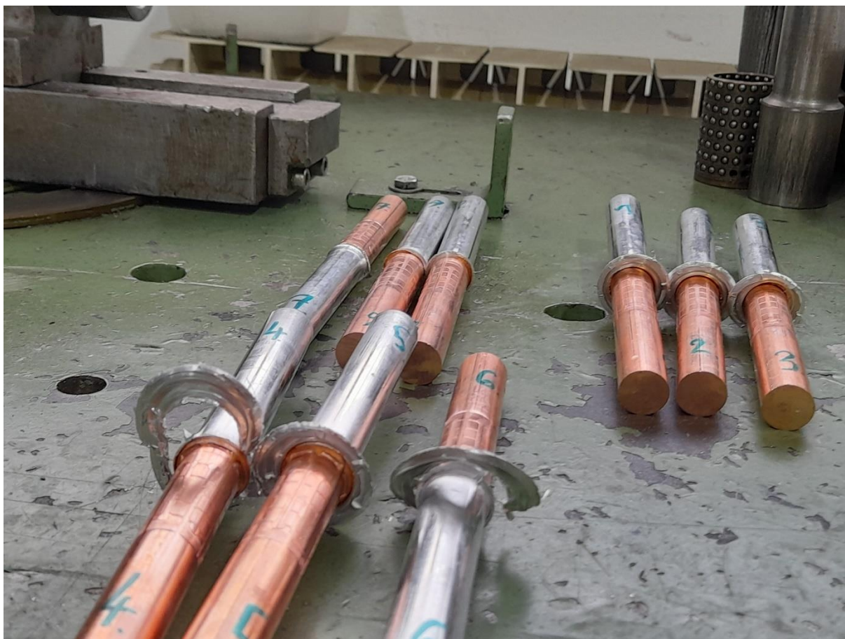
Slika 57. 3 grupe uzoraka sa različitim tlakom sabijanja i posljedično većim promjerom izbačenog materijala (srha)
