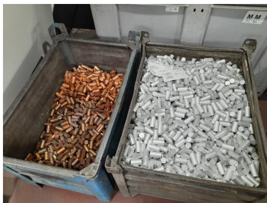
Slika 47. Cu i Al sirovci namijenjeni za zavarivanje trenjem
