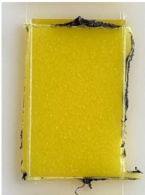
Slika 75. Zračni mjehuri unutar replike
