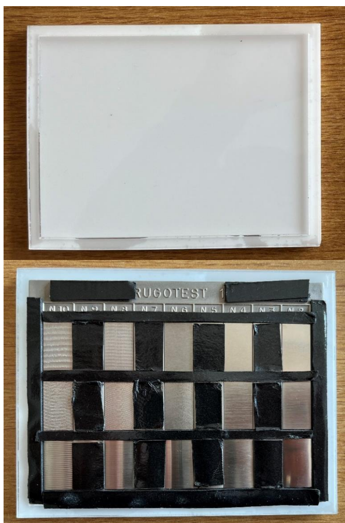
Slika 34. Ležište (donji dio kalupa)
