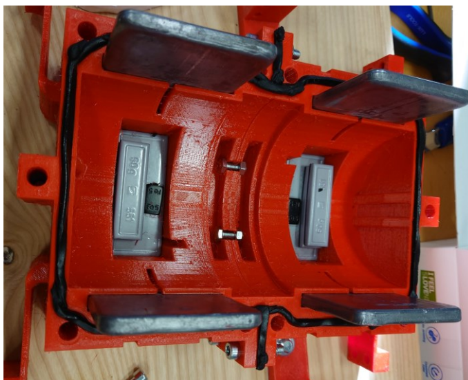
Slika 4.16 Vijčani spoj dvaju četvrtina primarne strukture
