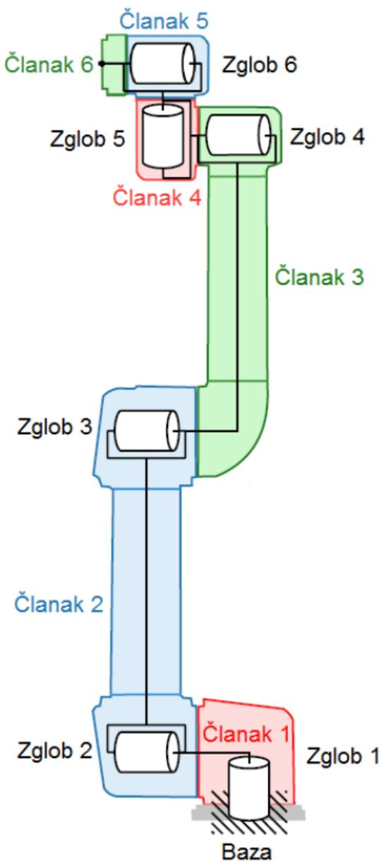
**Slika 5.2. Zglobovi i članci UR5 robota [23]**
