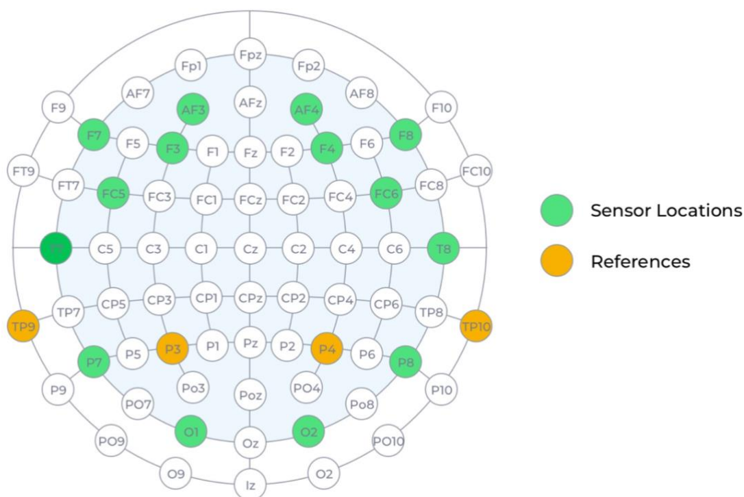
Slika 35. Prikaz elektroda koje uređaj koristi prema 10/20 sustavu [55]
