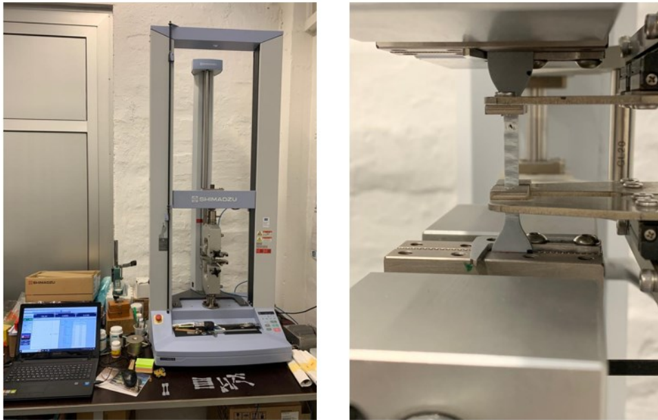
Slika 4.13 Kidalica Shimadzu AGS-X (lijevo), ispitna tijela u čeljustima kidalice tijekom vlačnog ispitivanja (desno)
