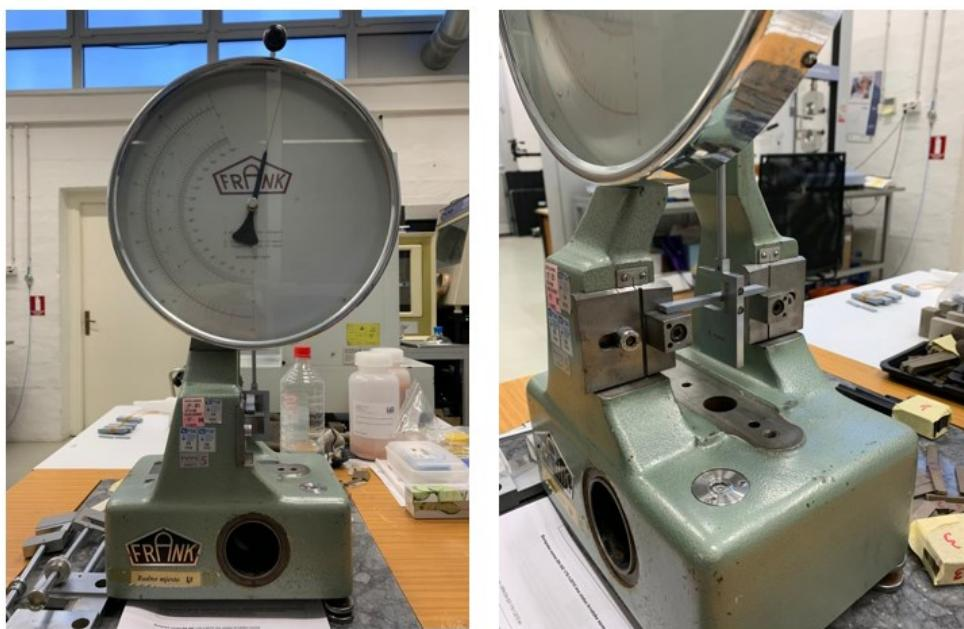
**Slika 4.10 Uredaj marke Frank za određivanje udarnog rada loma (lijevo), položaj ispitnog tijela na osloncima uređaja prilikom udara bata (desno)**
