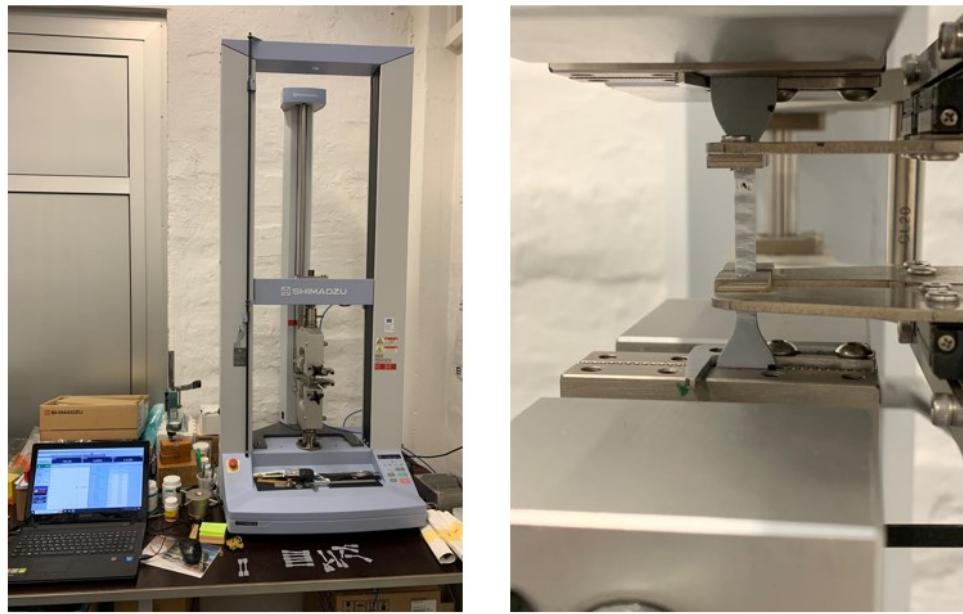
**Slika 4.13 Kidalica Shimadzu AGS-X (lijevo),
