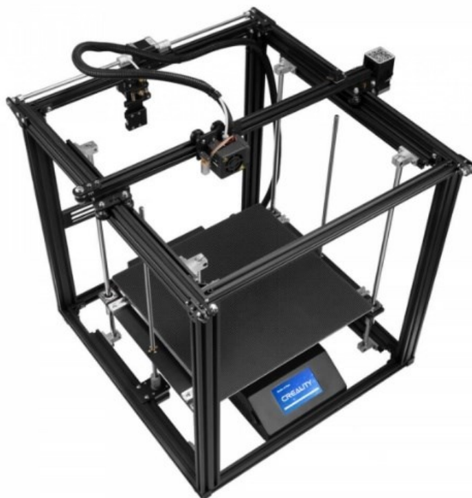
Slika 3.13 Primjer XY-head pisača ( Creality Ender 5 ) [30]
