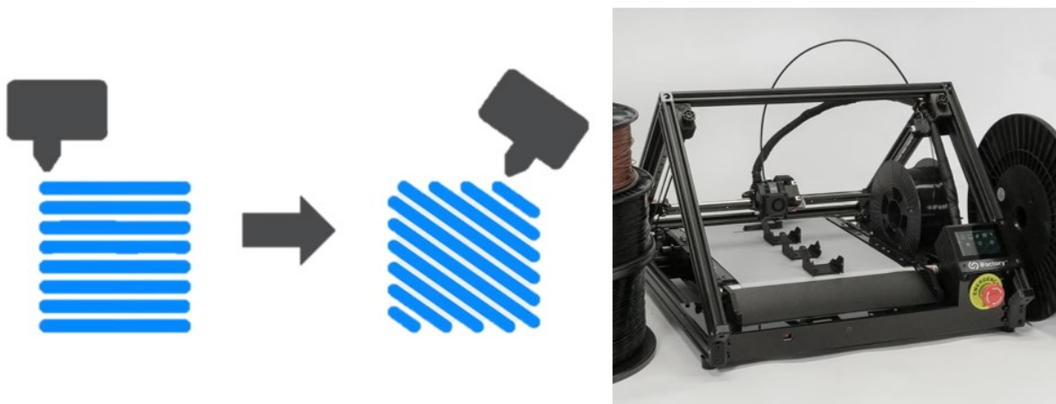
Slika 3.17 Putanja mlaznice kod ostalih FFF uređaja i kod Belt 3D pišača (lijevo), primjer Belt 3D pišača (desno) [29]
