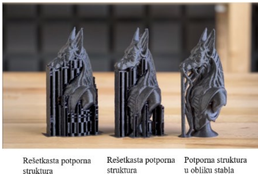
Slika 3.6 Dva osnovna oblika potporne strukture [6]
